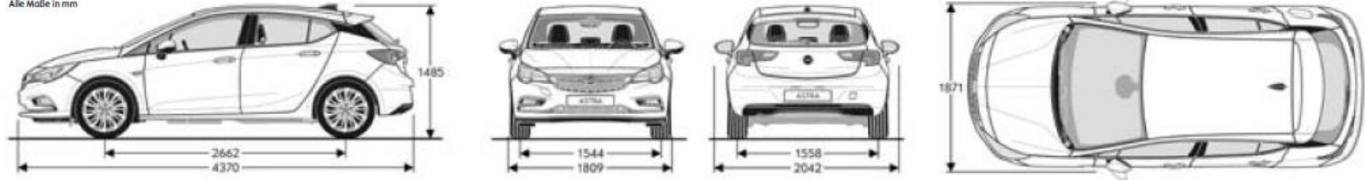
Breite mit eingeklappten Außenspiegeln 1871 mm
