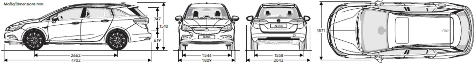
Breite mit eingeklappten Außenspiegeln 1871 mm
