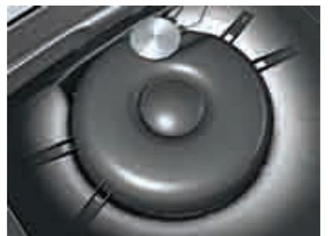
Il serbatoio GPL della Golf BiFuel è collocato nel vano della ruota di scorta ed occupa, pertanto, pochissimo spazio. La sua costruzione risponde, ai massimi standard di sicurezza.
