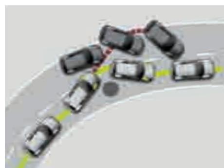
Golf offre di serie il programma elettronico di stabilità (ESP) che riconosce le situazioni di guida pericolose e previene in modo mirato lo sbandamento della vettura. Inoltre è equipaggiata con il dispositivo di assistenza alla controsterzata, ABS più assistenza comfort di frenata, MSR per la gestione della coppia in scalata. Su fondo scivoloso, la regolazione dello slittamento ruote (ASR) impedisce lo sbandamento della vettura.
