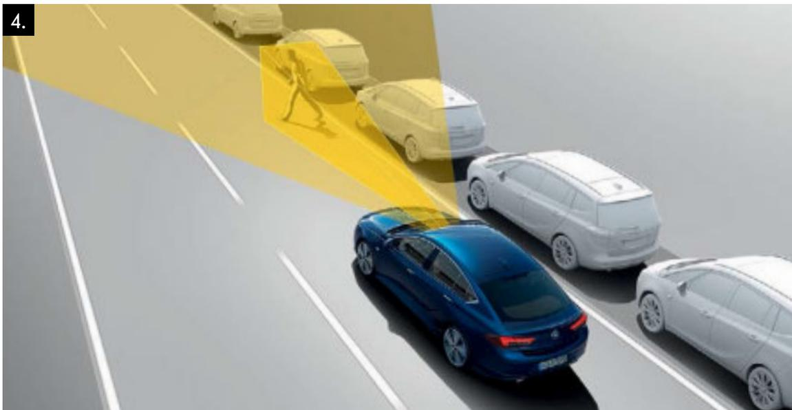
**4. Frenata di emergenza con sistema di rilevamento pedoni<sup>1,2</sup>.** Se il sistema rileva la presenza di un pedone, di un veicolo o di un altro oggetto, prepara l'impianto frenante e frena in modo autonomo in assenza di reazioni da parte del guidatore.
