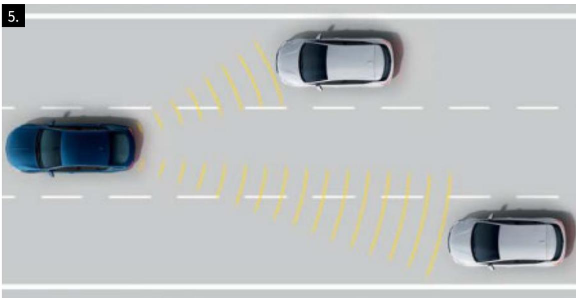
**5. Lane Change Assist con Side Blind Spot Alert<sup>4</sup>.** Emette un segnale di allerta se altri veicoli entrano nell'angolo cieco. Se hai già inserito l'indicatore di direzione per cambiare corsia, le icone lampeggiano e viene attivato anche un allarme sonoro.
