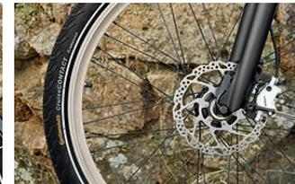
**Pneumatici:** i funzionali e sportivi Continental CruiseCONTACT permettono di affrontare qualsiasi fondo, poiché il grande volume d'aria e il profilo dinamico trasmettono una sensazione di guida sicura anche sui tratti sconnessi. Grazie al "Safety System" anche i detriti taglienti non sono più un problema.
