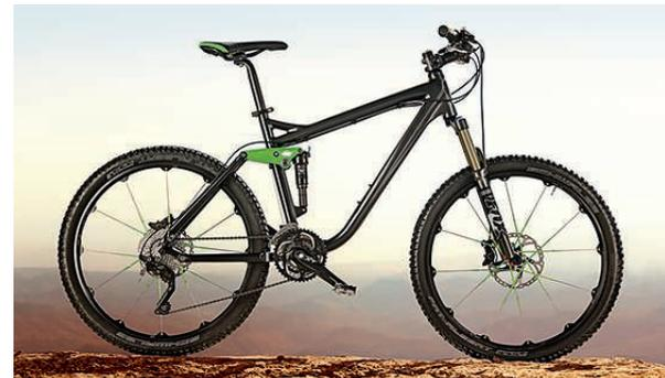
**Telaio:** con il telaio in alluminio biammortizzato e idroformato ogni urto è superato senza lasciare traccia, né sul ciclista né sulla bike.
