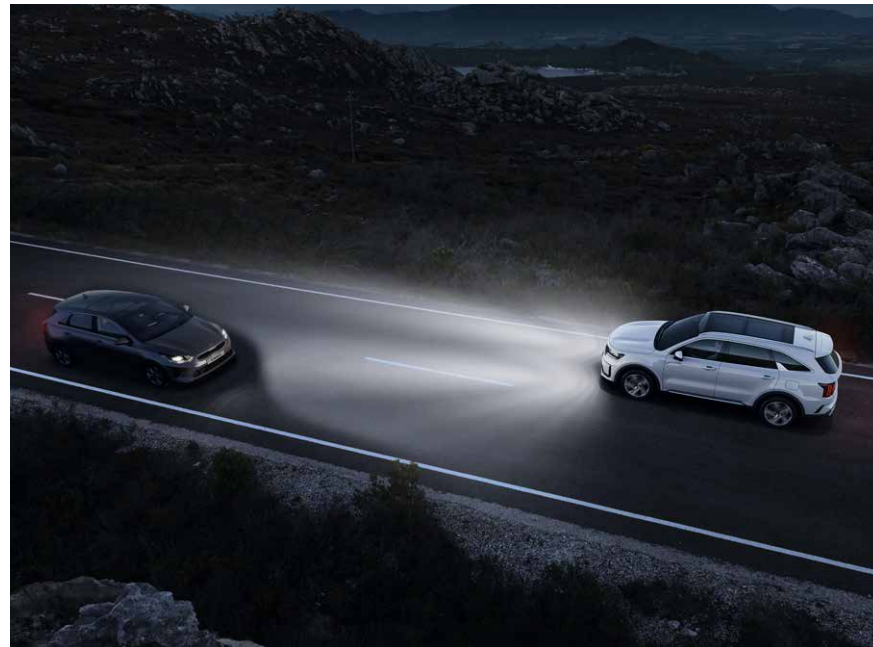
SISTEMA DI REGOLAZIONE AUTOMATICA FARI ABBAGLIANTI (HBA)
