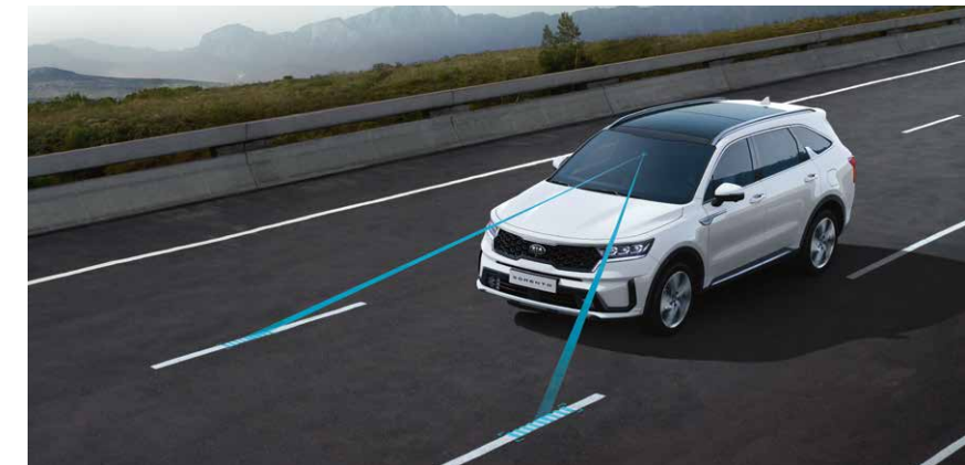
SISTEMA DI AVVISO E CORREZIONE SUPERAMENTO DELLA CARREGGIATA (LKA)
