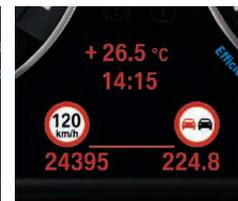
□ **Speed Limit Info** con indicazione di divieto di sorpasso: rileva i limiti di velocità e i divieti di sorpasso segnalandoli al guidatore sull'Info Display del quadro strumenti o sull'Head-Up Display BMW. Requisiti per questo equipaggiamento sono i sistemi di navigazione BMW Business<sup>2</sup> o BMW Connected Pro.
