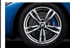
■ Cerchi M in lega leggera da 18" a doppi raggi n° 441 M, Runflat, con pneumatici misti; ant. 8 J x 18 con pneumatici 225/45 R 18, post. 8,5 J x 18 con pneumatici 255/40 R 18.
