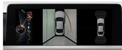
□ **Surround View:** offre al guidatore, nelle manovre, la vista dell'area vicina alla vettura, visualizzando la BMW nel Control Display con una proiezione dall'alto. Il Side View offre una visuale migliore all'uscita da posizioni con cattiva visibilità, ad esempio uscendo da un passo carrabile o da una strada con ostacoli laterali che ne impediscono la visibilità laterale (disponibile in abbinamento alla telecamera posteriore).
