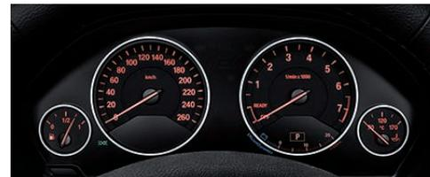
■ **Quadro strumenti analogico** per tachimetro, contagiri, indicatore del livello di carburante, termometro dell'olio nonché Info Display sul quale vengono indicati, ad esempio, la temperatura esterna e le funzioni del computer di bordo.
