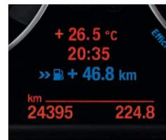
■ **Computer di bordo**: fornisce indicazioni sulla velocità media, sul consumo medio e istantaneo, sull'autonomia e sulla temperatura esterna.
