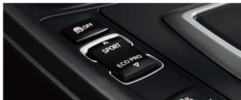
■ **Selettore del feeling di guida con modalità ECO PRO:** premendo un pulsante consente di guidare nelle modalità ECO PRO, Comfort, Sport o Sport+ (Sport+ solo in abbinamento a Sport Line, cambio automatico sportivo, assetto adattivo, M Sport Line o Variable Sport Steering). La speciale modalità ECO PRO invita ad una guida particolarmente efficiente.
