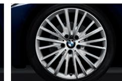
□ Cerchi in lega leggera da 19" multiraggio n° 399, Runflat, con pneumatici misti; ant. 8 J x 19 con pneumatici 225/40 R 19, post. 8,5 J x 19 con pneumatici 255/35 R 19.
