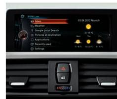
□ **BMW Live:** consente, tramite la connessione dati del vostro telefono cellulare connesso tramite Bluetooth, di accedere dalla vettura a servizi on-line. Si gestisce con l'iDrive Controller. Troverete informazioni in merito agli apparecchi compatibili su [www.bmw.it/bluetooth](http://www.bmw.it/bluetooth)
