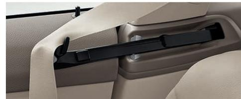
■ **Porgicintura automatico:** allunga automaticamente le cinture di sicurezza dai montanti centrali ai passeggeri anteriori (visibile nella foto).
