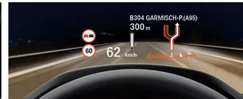
□ **Head-Up Display BMW interamente multicromatico**: proietta informazioni rilevanti per la guida direttamente nel campo visivo del guidatore (con occhiali da sole polarizzati la leggibilità è limitata), che può mantenere così lo sguardo sempre concentrato sulla strada. Vengono indicati ad esempio la velocità momentanea, le istruzioni per la navigazione, lo Speed Limit Info compresi i divieti di sorpasso, gli avvisi del Check Control e le informazioni di infotainment.
