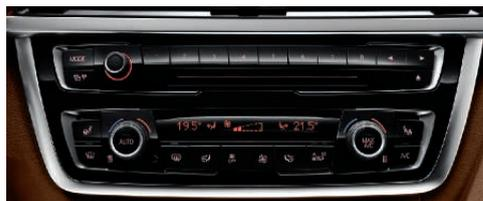
■ **Climatizzatore automatico con regolazione bizona**, regolazione della portata d'aria e della temperatura separata per lato guida e lato passeggero, bocchette di aerazione posteriori, controllo automatico del ricircolo d'aria (AUC), microfiltro, sensore antiappannamento, sensore solare e tasto di massimo raffreddamento.
