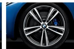
Cerchi M in lega leggera da 19" a doppi raggi n° 442 M, Runflat, con pneumatici misti; ant. 8 J x 19 con pneumatici 225/40 R 19, post. 8,5 J x 19 con pneumatici 255/35 R 19.
