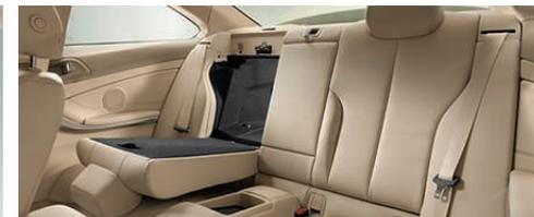
□ **Sistema di carico passante:** con schienale del sedile posteriore divisibile (40 : 20 : 40) per accrescere le possibilità di carico e ottenere una configurazione più individuale del sedile e del bagagliaio; bracciolo centrale con due portabevande (di serie). Una sacca portasci e portasnowboard adatta è disponibile negli Accessori Originali BMW.
