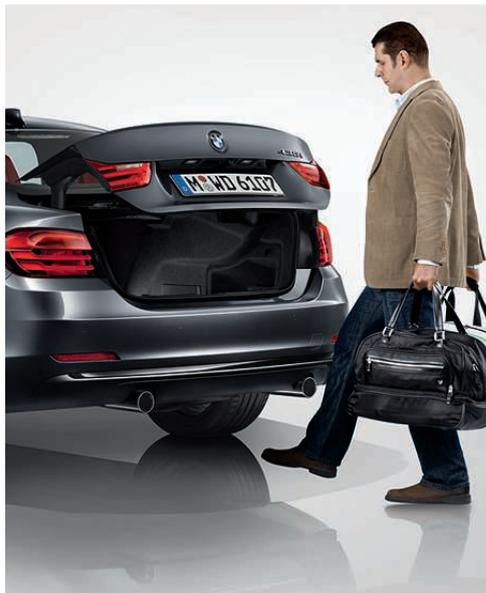
□ **Comfort Access**, per aprire e chiudere le portiere lato guida e passeggero nonché il cofano posteriore senza azionare il telecomando. Comprende l'illuminazione della zona di accesso nelle maniglie delle portiere nonché l'apertura del bagagliaio senza contatto manuale: basta muovere brevemente i piedi nella direzione prevista sotto il paraurti posteriore a circa 30 cm di distanza, che un sensore apre automaticamente il cofano posteriore.
