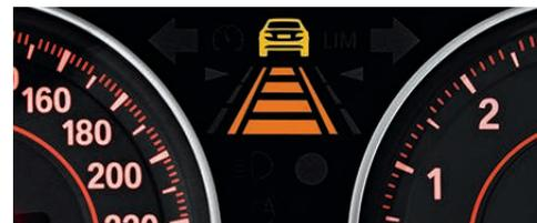
□ **Active Cruise Control con funzione Stop&Go<sup>2</sup>,** comprensivo di avviso tamponamento con rilevamento radar e funzione freno: regola automaticamente la velocità desiderata (fino a 210 km/h), anche nelle tipiche situazioni di Stop&Go.
