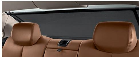
□ **Tendina parasole avvolgibile per il lunotto**, ad azionamento elettrico: protegge dai raggi solari e dagli sguardi curiosi (visibile nella foto).
