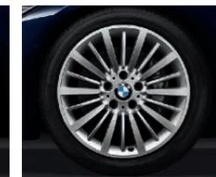
■ **Cerchi in lega leggera da 18" multiraggio n° 416** torniti a specchio, Runflat, 8 J x 18 con pneumatici 225/45 R 18.
