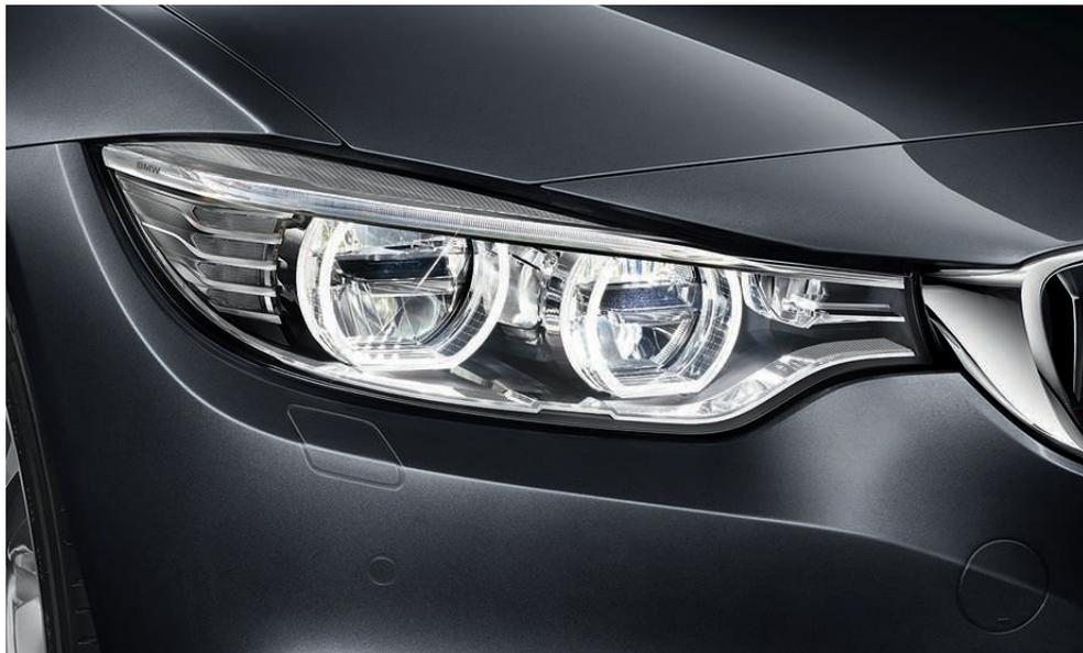
□ **Fari adattivi a LED** (visibili nella foto), comprensivi di palpebre luminose, luci anabbaglianti ed abbaglianti, High Beam Assistant antiabbagliamento, fari fendinebbia a LED, luci di svolta, indicatori di direzione, funzione di luce diurna e Adaptive Light Control con sistema di distribuzione variabile della luce: illuminano la strada in modo ottimale, assicurando una migliore visibilità ed una guida più riposante nei viaggi notturni... quasi come di giorno.
