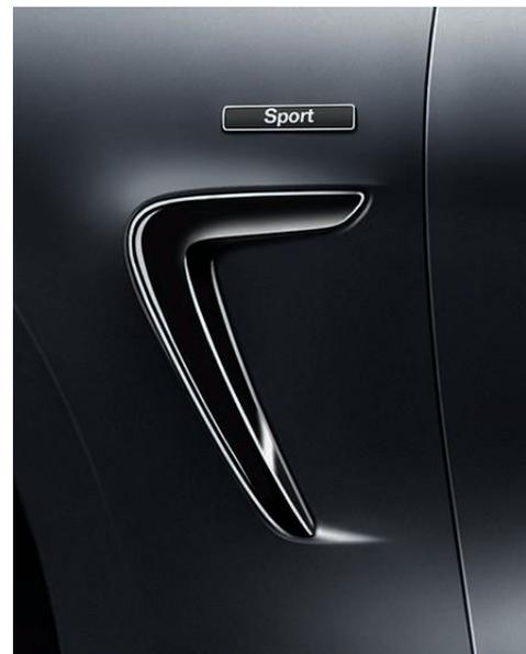
■ **Air Breather:** si trova nei passaruota anteriori e convoglia opportunamente i flussi d'aria attorno alle ruote. In tal modo si riduce la resistenza aerodinamica della vettura e diminuiscono sia i consumi che le emissioni di CO<sub>2</sub>. Nella foto è visibile l'Air Breather nero cromato (solo con BMW Sport Line o con Shadow Line lucida BMW Individual).
