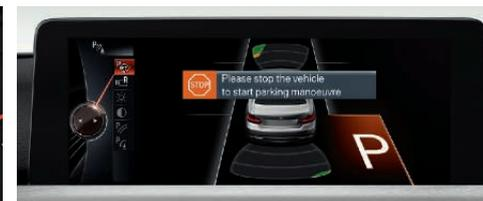
□ **Park Assistant:** facilita le manovre di parcheggio parallele alla corsia di marcia. A tale scopo il sistema misura gli spazi di parcheggio quando vi si passa accanto a velocità inferiori a 35 km/h. Se individua un parcheggio sufficientemente ampio, l'assistente esegue la manovra coadiuvato dal guidatore che accelera o frena.
