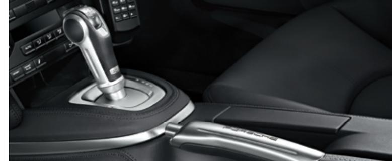
Leva selettoria per PDK/leva freno a mano in alluminio
