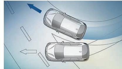
■ **Controllo dinamico della stabilità (DSC):** rileva costantemente le condizioni di marcia della vettura garantendo in ogni condizione di guida la massima stabilità e la miglior trazione possibili.
