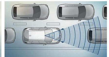
□ **Traffic Jam Assistant<sup>1</sup>:** sulle autostrade con traffico molto intenso, fino a 60 km/h regola automaticamente la velocità, la distanza e perfino la sterzata mantenendo il veicolo nella propria corsia di marcia.
