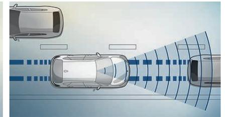
■ **Avvisatore di possibile tamponamento** (funzione di sicurezza basata su telecamera): individua i veicoli che viaggiano o sono fermi davanti alla vettura e avvisa il guidatore se la distanza si riduce troppo.
