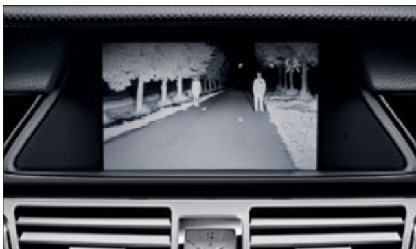
Il sistema Nightview Plus visualizza sul display ciò che si vedrebbe con gli abbaglianti accesi.
