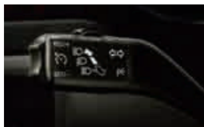
Regolatore di velocità per tutte le motorizzazioni per vetture con computer di bordo (3TO 035 623); per vetture senza computer di bordo (3TO 035 623A)
