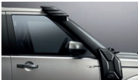
Convogliatore d'aria supplementare (snorkel) VPLAP0018 Non idoneo sui modelli benzina LR-V8 da 5,0 litri. Per i modelli TDV6 e SDV6 da 3,0 litri sono necessari particolari aggiuntivi venduti a parte. Tubo LR013711 Gomito PHD000714
