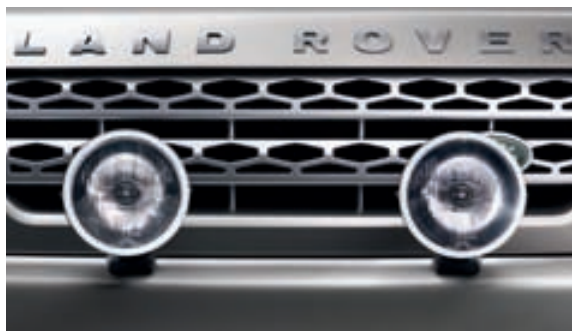
Staffe di montaggio per fari supplementari Coppia per montaggio sul paraurti VPLAV0020 Coppia per impiego con barra paracolpi VPLAV0021
