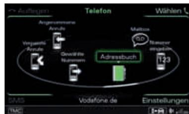
**Telefono:** la predisposizione per telefono cellulare (Bluetooth) o il sistema veicolare Bluetooth (fornibile a richiesta) sono dotati di uno schermo di selezione contenente elenchi di chiamate, rubrica e pulsante di selezione.
