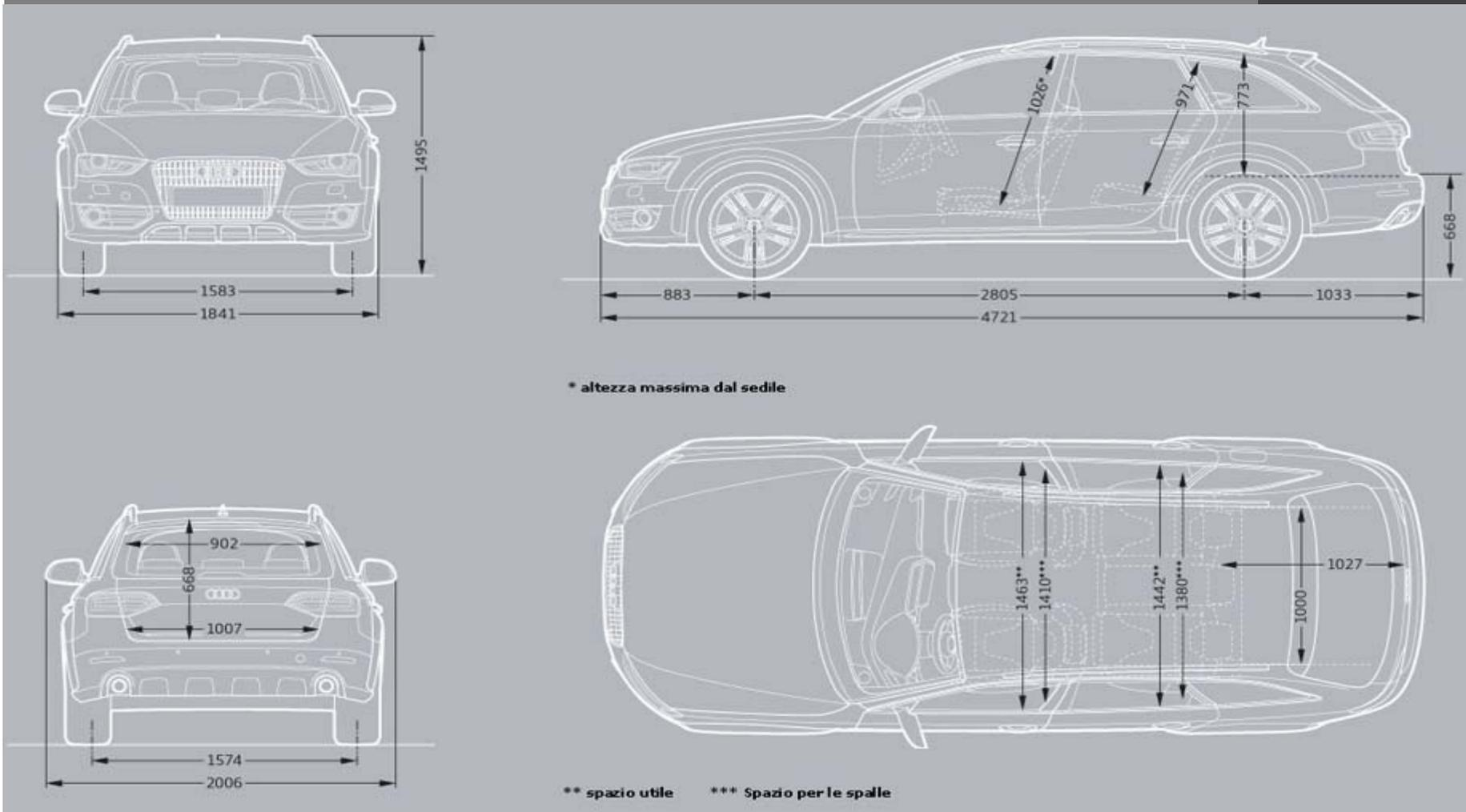
**Misure in millimetri.**
