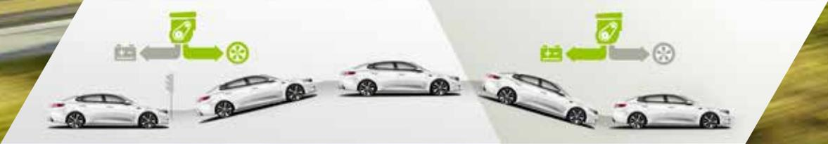
**Sistema di frenata rigenerativa:** l'energia cinetica prodotta durante la frenata o l'arresto viene recuperata e trasformata in energia elettrica per la ricarica della batteria.
