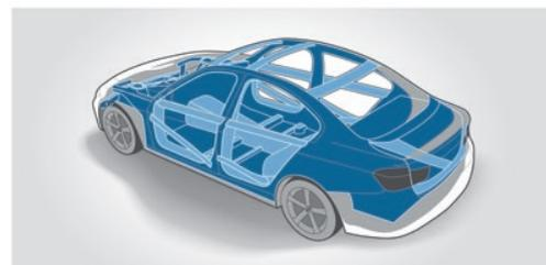
■ **Cellula abitacolo**: grazie alla sua struttura funzionale con speciale dislocazione degli elementi portanti e speciali collegamenti nodali, nonché all'impiego mirato di materiali ad alta resistenza, offre un grado ottimale di sicurezza passiva in caso di impatto frontale, laterale e posteriore. La struttura di questa carrozzeria è in grado di assorbire energia d'urto mediante zone deformabili predefinite e contribuisce così in ampia misura alla protezione dei passeggeri.
