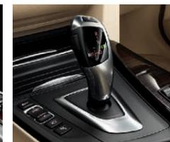
□ **Cambio automatico a 8 rapporti** con selettore marce elettronico e gestione adattiva: consente una guida riposante ed efficiente (di serie per ActiveHybrid 3 e 330d).
