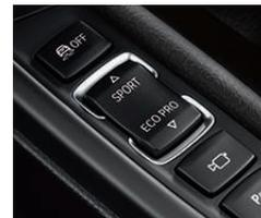
■ **Selettore del feeling di guida con modalità ECO PRO<sup>2</sup>:** premendo un pulsante, consente di guidare nelle modalità «ECO PRO», «Comfort», «Sport» o «Sport+» («Sport+» solo in abbinamento a Sport Line, cambio automatico sportivo, Variable Sport Steering, assetto adattivo o Assetto Sportivo M). Offre inoltre la modalità ECO PRO che invita ad una guida particolarmente efficiente.
