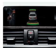
□ **Park Distance Control (PDC),** disponibile per parte anteriore e posteriore o soltanto posteriore: facilita il parcheggio e la manovra in spazi ristretti; l'avvicinamento dell'auto ad un ostacolo viene indicato tramite segnali acustici e visualizzato nel Control Display.
