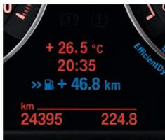
■ **Computer di bordo:** fornisce indicazioni sulla velocità media, sul consumo medio e momentaneo, sull'autonomia e sulla temperatura esterna; quando è attiva la modalità ECO PRO visualizza anche il «bonus di autonomia».
