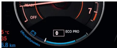
■ **Funzione Auto Start Stop:** nelle brevi soste, ad esempio ai semafori, spegne temporaneamente il motore riducendo il consumo di carburante. Una spia nel contagiri segnala al guidatore se la funzione è attiva.
