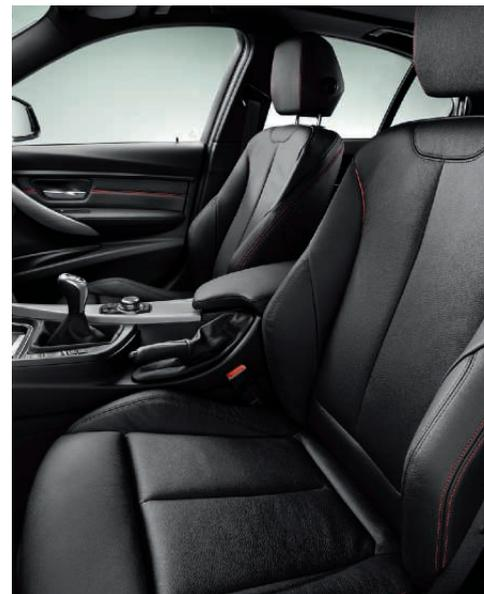
□ **Sedili anteriori sportivi** (di serie in abbinamento a Sport Line e Pacchetto Sportivo M): garantiscono un sostegno laterale perfetto grazie allo schienale regolabile elettricamente in larghezza. La posizione longitudinale, l'altezza e l'inclinazione del sedile, l'inclinazione dello schienale e l'appoggio gambe sono regolabili manualmente (nella foto: Sport Line con cuciture in contrasto rosse o nere a scelta).
