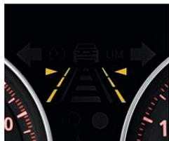
□ **Avvisatore di cambio accidentale della corsia di marcia:** con avvertimento di possibile tamponamento basato su telecamera: rileva se l'auto si avvicina ad una striscia di delimitazione di una corsia di marcia, avvisando il guidatore tramite una leggera vibrazione del volante (solo in abbinamento a Quadro strumenti con funzioni estese).
