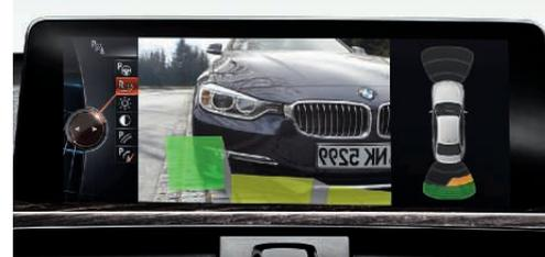
**Telecamera per retromarcia.** Sul Control Display viene visualizzata un'immagine dell'area dietro la vettura, che permette di orientarsi meglio nelle manovre di parcheggio con la retromarcia e a velocità inferiori a 20 km/h. Vengono anche indicate linee guida di manovra ed eventuali ostacoli.
