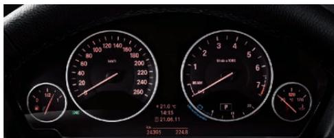
■ **Quadro strumenti** con quattro strumenti analogici per tachimetro, contagiri, indicatore del livello di carburante, termometro dell'olio nonché Info Display sul quale vengono indicati, ad esempio, la temperatura esterna e le funzioni del computer di bordo.
