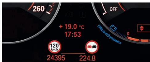
□ **Speed Limit Info con indicazione di divieto di sorpasso:** rileva il limite di velocità momentaneo o un eventuale divieto di sorpasso e li indica nell'Info Display o nell'Head-Up Display BMW (optional) (solo in abbinamento ai Sistemi di navigazione BMW e al quadro strumenti con funzioni estese).
