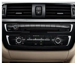
■ **Climatizzatore automatico con regolazione monozona** e microfiltro
