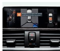
□ **Park assistant:** facilita le manovre di parcheggio parallele alla corsia di marcia. A tale scopo il sistema misura gli spazi di parcheggio quando vi si passa accanto a velocità inferiori a 35 km/h. Se individua un parcheggio sufficientemente ampio, l'assistente esegue la manovra, coadiuvato dal guidatore che accelera o frena.
