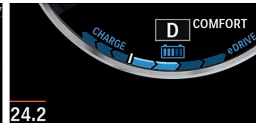
■ **Funzione Boost.** Quando occorre, l'energia della batteria high performance integra la propulsione elettrica accrescendo per breve tempo la potenza complessiva del veicolo. Uno dei vantaggi di questa tecnologia è appunto l'erogazione pronta e poderosa della potenza.
