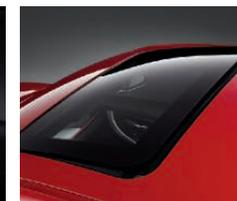
□ **Tettuccio in vetro ad azionamento elettrico,** con funzioni di scorrimento ed inclinazione nonché apertura e chiusura «comfort» tramite telecomando e azionamento mediante un semplice impulso. Assicura una circolazione ottimale dell'aria e un'illuminazione naturale dell'abitacolo.
