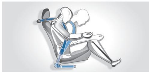
■ **Sistema di ritenzione BMW** per guidatore e passeggero: consiste in una combinazione di cintura di sicurezza a tre punti, pretensionatori e limitatori di ritenzione che assicura la massima efficacia di ritenzione in caso d'urto. Per evitare l'allacciamento errato delle cinture nella zona posteriore i fermi delle cinture sono codificati.
