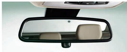
□ **Retrovisore interno autoanabbagliante:** di grandi dimensioni, si oscura automaticamente a seconda dell'intensità luminosa dei fari di veicoli che seguono.
