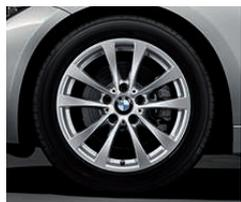
Cerchi in lega leggera da 17" raggi a V n° 395 con pneumatici misti: ant. 7,5 J x 17, pneu. 225/50 R 17; post. 8,5 J x 17, pneu. 255/45 R 17.
