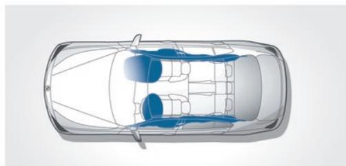
■ **Airbag**: fanno parte del sistema di sicurezza BMW nel quale tutti i componenti sono armonizzati in modo ottimale. Sei airbag assicurano una protezione mirata: gli airbag lato guidatore e passeggero, gli airbag per la testa anteriori e posteriori a tendina e gli airbag laterali integrati negli schienali dei sedili anteriori.
