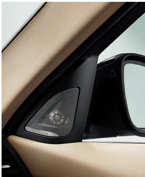
□ **Sistema HiFi Surround Sound Harman Kardon** con potente amplificatore digitale da 600 Watt, equalizzatore specifico per la vettura, centerspeaker e 16 altoparlanti per un suono perfetto. In abbinamento all'impianto è inoltre presente una pregiata mascherina in alluminio anodizzato con logo nel supporto triangolare dei retrovisori esterni.
