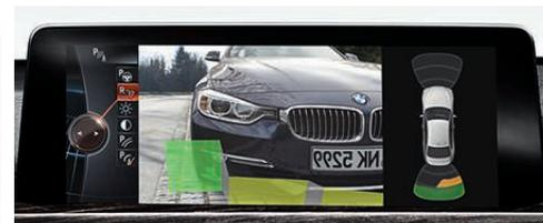
□ **Telecamera posteriore:** visualizza chiaramente sul Control Display la zona dietro la vettura. La telecamera posteriore permette di orientarsi meglio nelle manovre di parcheggio con la retromarcia a velocità inferiori a 20 km/h. Nei modelli con gancio di traino la telecamera è dotata anche della funzione zoom (disponibile in abbinamento al Park Distance Control).
