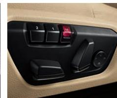
□ **Regolazione elettrica dei sedili:** regolazione del sedile in altezza, inclinazione e scorrimento avanti/indietro nonché inclinazione dello schienale; funzione Memory per sedile di guida e retrovisori esterni (compreso dispositivo automatico «bordo marciapiede»).
