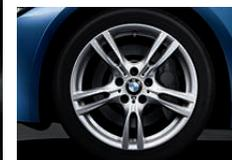
■ Cerchi in lega leggera M da 18" a doppi raggi n° 400 M Runflat con pneumatici misti, ant. 8 J x 18, pneu. 225/45 R 18; post. 8,5 J x 18, pneu. 255/40 R 18.
