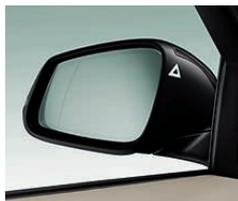
□ **Segnalatore di sorpasso pericoloso (Lane Change Warning)** segnala immediatamente al guidatore, attraverso una vibrazione sul volante o un'indicazione ottica nel retrovisore esterno, se una vettura si trova nell'«angolo cieco» dello specchio retrovisore o se una vettura si avvicina con velocità elevata.
