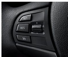
□ **Cruise Control con funzione freno:** memorizza, a partire da circa 30 km/h, la velocità desiderata e la mantiene costante anche nelle discese, con tasti multifunzione per volante. Equipaggiamento senza funzionalità Speed Limit.
