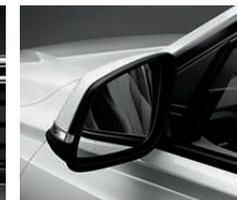
■ **Retrovisori esterni** in tinta carrozzeria, regolabili elettricamente, specchio asferico sul lato guida; con indicatore di direzione supplementare con tecnologia LED. Per la Sport Line disponibile su richiesta in Black Lucido.
