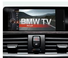
□ **Funzione TV:** consente di utilizzare come televisore il Control Display (soltanto a vettura ferma). Si possono ricevere programmi digitali (DVB-T) (solo in abbinamento al Sistema di Navigazione BMW Connected Pro).
