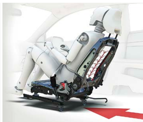
Sistema di protezione contro il colpo di frusta (WHIPS)
