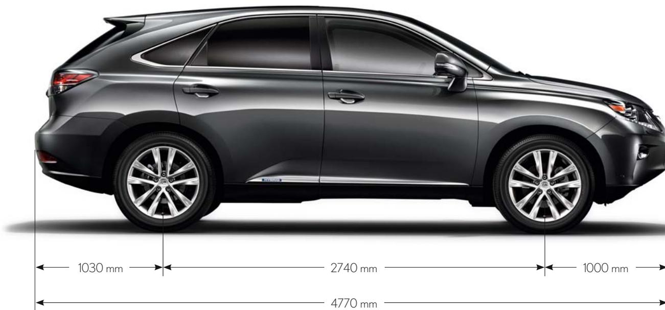
\* Altezza totale = 1680 mm (+30 mm in modalità Hi, -20 mm anteriore / 5 mm posteriore in modalità Lo e - 30 mm in modalità di carico) se equipaggiata con le sospensioni pneumatiche.
