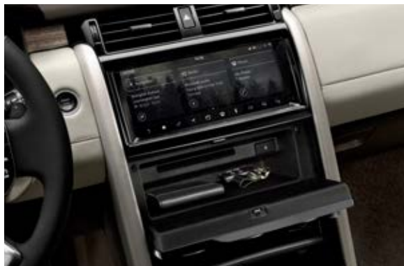
Vano portaoggetti della console centrale dietro i comandi della climatizzazione 1
