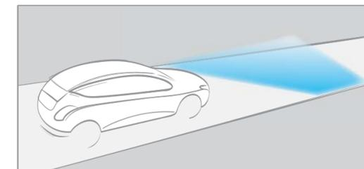
**DRIVING ADVISOR (SISTEMA DI AVVISO DI USCITA DALLA CORSIA).** Il dispositivo di sicurezza preventiva che avvisa il guidatore dell'eccessivo avvicinamento al bordo della corsia, suggerendo la traiettoria corretta per riportare la vettura in carreggiata.
