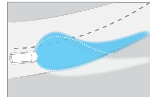
**ADAPTIVE XENON LIGHT E FOG CORNERING LIGHT.** Il sistema che orienta il fascio luminoso dei fari allo Xenon, adattandosi automaticamente alla strada. I fendinebbia con funzione cornering, che si accendono in base alla direzione della curva, si integrano al dispositivo garantendo un'illuminazione ottimale della strada.
