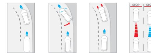
**ABSOLUTE HANDLING SYSTEM E DST.** Il sistema, evoluzione dell'ESP, garantisce un controllo perfetto della vettura e ne ottimizza la stabilità in ogni condizione di guida. A questo si aggiungono il DST (Driving Steering Torque), lo sterzo elettronico attivo che effettua automaticamente le correzioni, il LTF (Linearization Torque Feedback) e il TTC (Torque Transfer Control) per un migliore controllo della vettura in curva.
