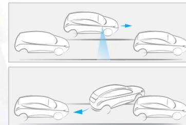
**MAGIC PARKING.** Il sistema di parcheggio semi-assistito che aiuta il conducente a riconoscere un'area di sosta dalle dimensioni adeguate a quelle della vettura, per poi impostarne la manovra di inserimento agendo automaticamente sullo sterzo.
