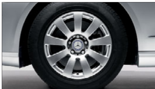
Cerchi in lega a 9 razze (di serie) con pneumatici 205/60 R 16 (non disponibili per i modelli station-wagon) o 225/55 R 16 (a seconda della motorizzazione)
