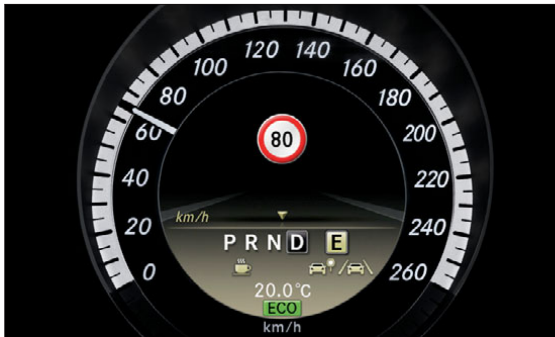
Lo Speed Limit Assist visualizza anche limiti di velocità temporanei.
