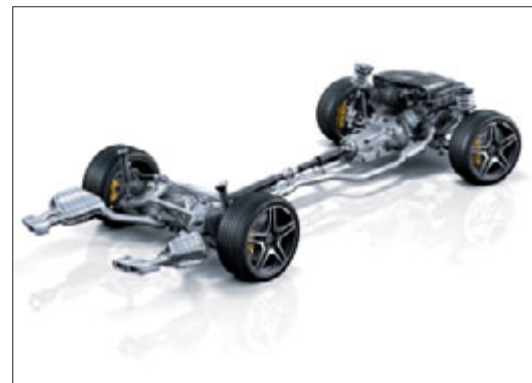
Assetto sportivo RIDE CONTROL AMG con ampio asse anteriore per una dinamica trasversale ottimizzata
