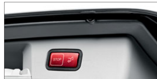
Con un semplice pulsante è possibile arrestare la corsa del portellone EASY-PACK lasciandolo anche in una posizione più bassa.
