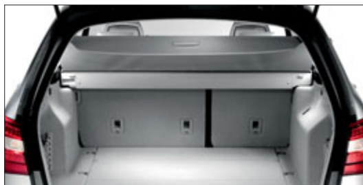
Aprendo il portellone posteriore, la copertura del bagagliaio EASY-PACK si solleva.
