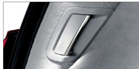
Grazie al Quickfold EASY-PACK sul secondo montante posteriore è possibile ribaltare gli schienali posteriori anche dal bagagliaio.
