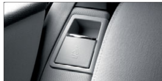
La maniglia di sbloccaggio sul montante posteriore agevola notevolmente il ribaltamento degli schienali posteriori.
