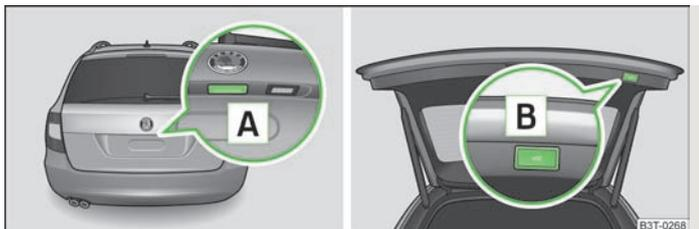
Fig. 22 Azionamento del portellone
