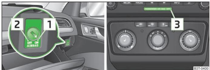
Fig. 149 Scomparto portaoggetti: Interruttore per disabilitazione dell'airbag frontale lato passeggero / spia di controllo per disabilitazione dell'airbag frontale lato passeggero
