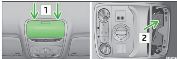
Fig. 28 Vano del padiglione del tetto / punto di applicazione della chiave
