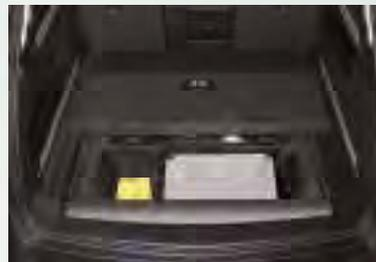
**Vano di carico sotto la superficie del bagagliaio<sup>1</sup>.** Per tutti quegli oggetti utili che non si vuole tenere a vista, c'è un vano della capacità di 73 litri, in presenza del kit riparazione pneumatici, nascosto sotto la superficie del bagagliaio.
