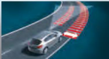
**Allarme della corsia di marcia.** Si attiva se la vettura oltrepassa involontariamente una linea continua della segnaletica orizzontale. Una spia ed un messaggio sonoro disattivabile avvertono il guidatore.
