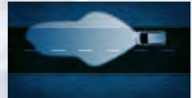
**Luce autostradale (oltre 100 km/h).** La profondità del fascio luminoso sale a 140 metri. E' più intenso e brillante di un normale anabbagliante.
