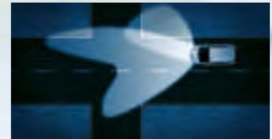
**Illuminazione statica delle curve (fino a 40 km/h ed in retromarcia).** Questa funzione inclina i fari di 90 gradi a destra ed a sinistra per migliorare la visione laterale. In retromarcia migliora la visibilità dell'area di parcheggio.
