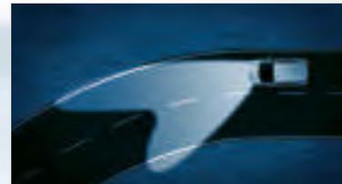
**Illuminazione dinamica delle curve (a qualsiasi velocità).** I fari, seguendo la velocità della vettura, ruotano fino a 15 gradi verso l'interno della curva.
