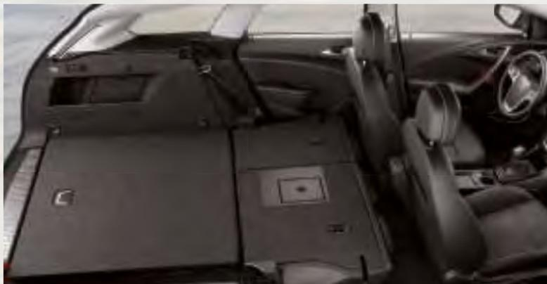
**Ancora più funzionale.** La possibilità di rimuovere facilmente le sedute dei sedili posteriori permette di aumentare ulteriormente la capacità del vano di carico oppure di approfittare dell'ampia escursione longitudinale dei sedili anteriori.
