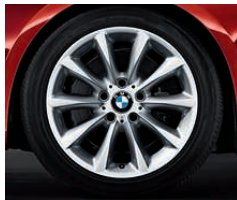
□ Cerchi in lega leggera da 18" styling a stella n° 340 con pneumatici misti, ant. 8 J x 17, pneumatici 225/45 R 17, post. 8,5 J x 17, pneumatici 255/40 R 17 (di serie per 335i e 335d).
