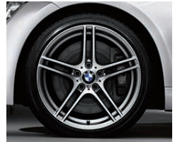
Cerchi in lega leggera M da 19" styling a raggi doppi n° 313 M con pneumatici misti 1 , ant. 8 J x 19, pneumatici 225/35 R 19, post. 9 J x 19, pneumatici 255/30 R 19 (cod.2B6).
