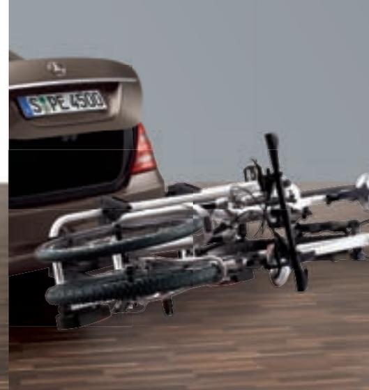
*Il portabiciclette posteriore carico si può inclinare all'indietro, permettendo così di aprire comodamente il bagagliaio. In alternativa, se il portabiciclette posteriore non è carico, basta ribaltare la staffa di supporto verticale per accedere al bagagliaio. Inoltre questa funzione permette di conservare il portabiciclette smontato risparmiando spazio.*
