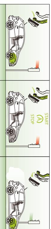
Quando la vettura si ferma è sufficiente mettere il cambio in folle rilasciare la frizione affinché il sistema Start/Stop spenga il motore. Premendo nuovamente la frizione, il motore si riavvia.
