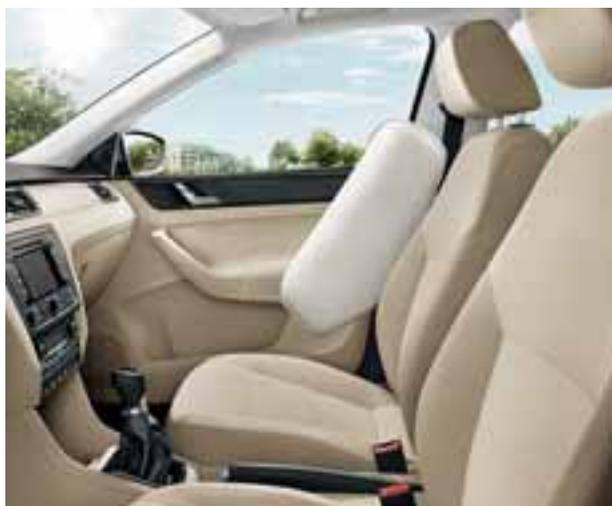
Gli **airbag laterali** nella parte anteriore dell'abitacolo proteggono il bacino e il torace del conducente e del passeggero in caso di impatto laterale. I **poggiatesta anteriori** sono regolabili in altezza.
