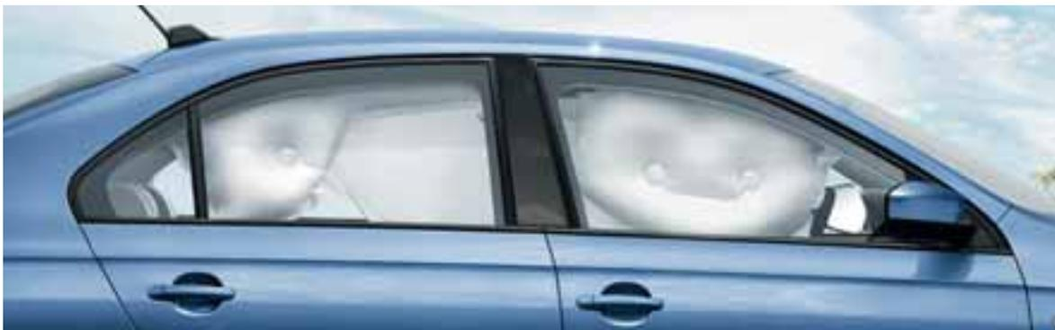
Rapid è **sicura** anche in condizioni estreme. Ci puoi contare. La dotazione di serie include un'ampia gamma di sistemi di sicurezza, tra cui l'**ESC** (Electronic Stability Control) con **ABS** (Anti-Braking System) e **sei airbag**. Gli **airbag per la testa** una volta attivati creano una barriera che protegge i passeggeri sui sedili anteriori e posteriori da possibili urti.
