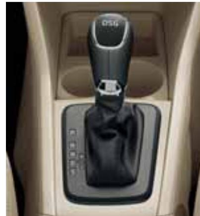
Il **cambio automatico DSG** (Direct Shift Gearbox) a 7 rapporti, di serie sulle vetture con motore 1,4 TSI/90 kW, concentra in sé i vantaggi della trasmissione manuale e di quella automatica tradizionale. La velocità nell'impostazione delle marce consente un'ottima ripresa. In modalità optimum gear, il cambio DSG mantiene il numero di giri ottimali e, con una guida economica, ciò consente di risparmiare carburante e di ridurre le emissioni di CO<sub>2</sub>.
