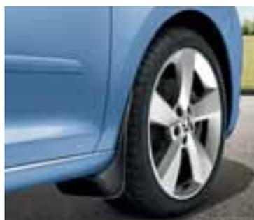
**Set di 2 paraspruzzi anteriori** e kit di montaggio per le ruote anteriori. Proteggono la vernice da fango, neve, ghiaia e sassi. Non richiedono fori alla carrozzeria.
