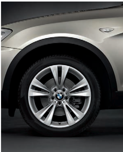
Cerchi in lega leggera a doppi raggi n° 309 da 19 2 : con pneumatici misti; anteriori 8,5 J x 19 con pneumatici 245/45 R 19, posteriori 9,5 J x 19 con pneumatici 275/40 R 19.
