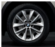
Cerchi in lega leggera raggi a V n° 307 da 18 1 : 8 J x 18 con pneumatici 245/50 R 18 (di serie per X3 xDrive28i, X3 xDrive35i e X3 xDrive30d 2 ).
