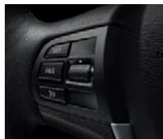
Regolatore di velocità con funzione freno: a partire da circa 30 km/h memorizza la velocità preselezionata, la indica nel display delle informazioni e la mantiene costante. Frenando, la funzione viene disattivata.
