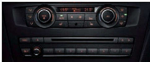
Climatizzatore automatico a 2 zone con controllo automatico del ricircolo d'aria (AUC), filtro a carbone attivo, sensore solare e sensore appannamento. Realizza velocemente il clima desiderato e mantiene costante la temperatura selezionata. Regolazione della temperatura nella zona anteriore (separata per lato destro e sinistro); regolazione dell'aerazione e climatizzazione nella zona posteriore.
