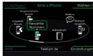
**Telefono cellulare/Bluetooth:** la predisposizione cellulare (Bluetooth) e il Bluetooth con sistema veicolare Audi sono dotati di uno schermo di selezione contenente elenchi di chiamate, rubrica e pulsante di selezione.
