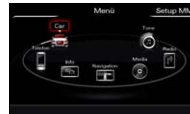
**Car:** questa funzione consente di controllare direttamente i sistemi di assistenza alla guida, regolazioni della vettura, climatizzatore e service.
