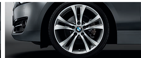
□ Cerchi in lega leggera da 18" a doppi raggi n° 384 , Runflat, con pneumatici misti: ant. 7,5 J x 18 con pneumatici 225/40 R 18, post. 8 J x 18 con pneumatici 245/35 R 18 (di serie per 225d).
