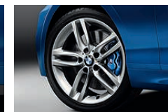
□ Cerchi M in lega leggera da 18" a doppi raggi n° 461 M, Runflat, con pneumatici misti; ant. 7,5 J x 18 con pneumatici 225/40 R 18, post. 8 J x 18 con pneumatici 245/35 R 18.
