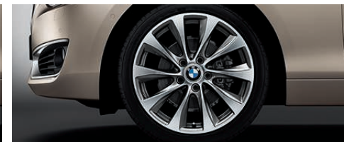
□ Cerchi in lega leggera da 18" raggi a V n° 387 , Runflat, con pneumatici misti: ant. 7,5 J x 18 con pneumatici 225/40 R 18, post. 8 J x 18 con pneumatici 245/35 R 18 (di serie per 225d).
