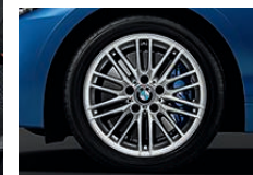
■ Cerchi M in lega leggera da 17" a doppi raggi n° 460 M con pneumatici misti; ant. 7,5 J x 17 con pneumatici 225/45 R 17, post. 8 J x 17 con pneumatici 245/40 R 17.
