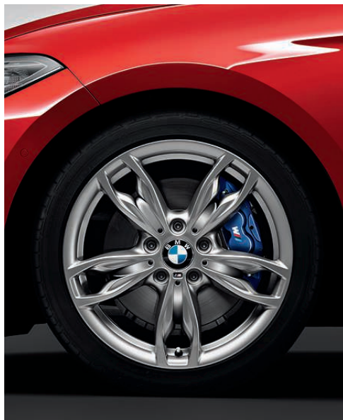
■ Cerchi M in lega leggera da 18" a doppi raggi n° 436 M color Ferric Grey con pneumatici misti: ant. 7,5 J x 18 con pneumatici 225/40 R 18; post. 8 J x 18 con pneumatici 245/35 R 18 (solo per M235i).
