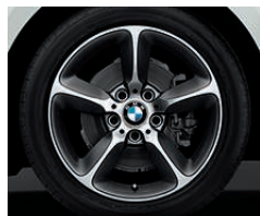
□ Cerchi in lega leggera da 17" raggi a stella n° 382 , bicolore Space Grey metallizzato, torniti a specchio, Runflat, con pneumatici misti: ant. 7,5 J x 17 con pneumatici 225/45 R 17, post. 8 J x 17 con pneumatici 245/40 R 17.
