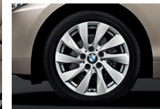
■ Cerchi in lega leggera da 17" styling a turbina n° 381, Runflat, 7,5 J x 17 con pneumatici 225/45 R 17.
