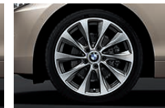
□ Cerchi in lega leggera da 18" raggi a V n° 387, Runflat, con pneumatici misti; ant. 7,5 J x 18 con pneumatici 225/40 R 18, post. 8 J x 18 con pneumatici 245/35 R 18 (di serie per 225d).
