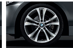
□ Cerchi in lega leggera da 18" a doppi raggi n° 384, Runflat, con pneumatici misti; ant. 7,5 J x 18 con pneumatici 225/40 R 18, post. 8 J x 18 con pneumatici 245/35 R 18 (di serie per 225d).
