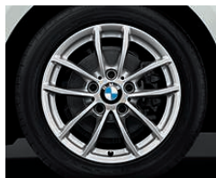
■ Cerchi in lega leggera da 16" raggi a V n° 378 , 7 J x 16 con pneumatici 205/55 R 16 (di serie per 220i, 218d 1 e 220d).
