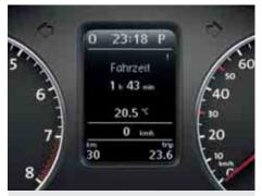
Durante il viaggio il **display multifunzionale** fornisce informazioni importanti come i valori di consumo, la velocità media, l'autonomia di carburante, il tragitto da percorrere nonché l'ora e la temperatura esterna.
