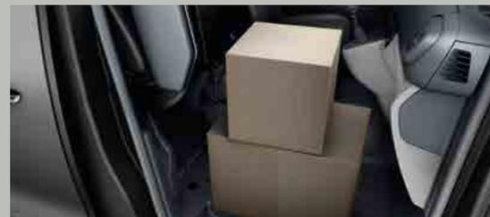
La seduta del sedile passeggero sollevabile si abbatte contro lo schienale liberando un pavimento completamente piatto. Lo Smart Cargo consente di incrementare il volume di carico di 0,5m<sup>3</sup>\*
