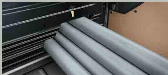
La paratia apribile dello Smart Cargo consente di incrementare la lunghezza del vano di carico di 1,16m permettendo di trasportare oggetti lunghi fino a 4 metri nella configurazione Long.
