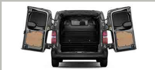
Proace Long è disponibile con un portellone posteriore doppio apribile a 180° su tutte le versioni e fino a 250° per la configurazione Long con allestimento Comfort, per agevolare anche le operazioni di carico e scarico più impegnative.
