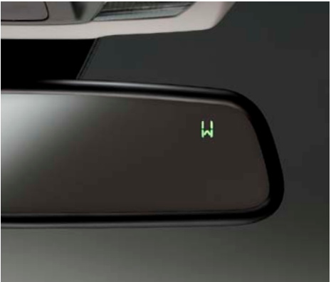
Retrovisore interno con funzione antiabbagliamento automatica
