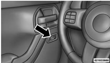
Interruttore chiusura porte centralizzata
