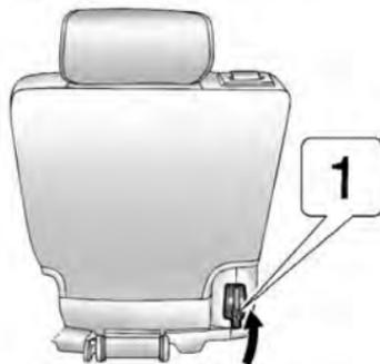
3. Sollevare la leva di sblocco "1" posizionata sulla parte bassa posteriore dello schienale sul lato esterno del sedile, e lo schienale si ribalterà in avanti.
