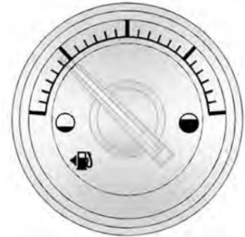
Con l'accensione inserita, l'indicatore del livello di carburante indica la quantità di carburante residuo nel serbatoio.
