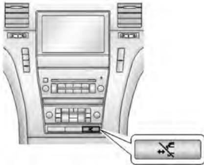
Il veicolo può essere dotato di gradini servoassistiti. Per abilitare o disabilitare i gradini servoassistiti premere
