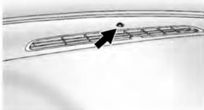
Il veicolo è dotato di un sensore per la luce che si trova in alto nel cruscotto, che regola l'accensione automatica dei fari. Non coprire il
