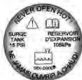
1. Togliere il tappo a pressione del vaso di espansione del liquido di raffreddamento quando l'impianto di raffreddamento, incluso il tappo a pressione del vaso di espansione del liquido di raffreddamento e il tubo flessibile del radiatore superiore, non sono più bollenti.
