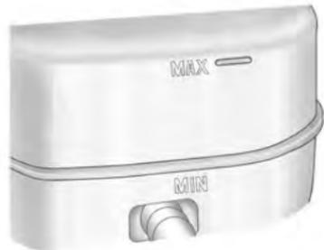
Il livello del liquido deve superare la tacca MIN (min.). In caso contrario, far controllare l'impianto idraulico per eventuali perdite.
