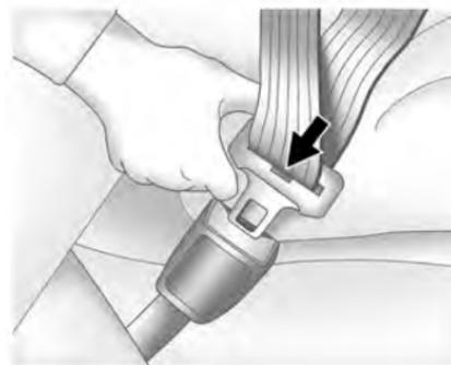
3. Inserire la linguetta di chiusura nella fibbia fino a quando non scatta in posizione. Se riscontrate che la piastra di chiusura non entra completamente nella fibbia, controllate se state utilizzando la fibbia corretta.
