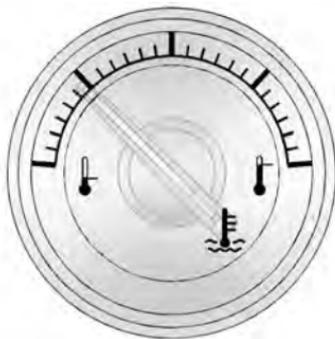
Questo indicatore indica la temperatura del liquido di raffreddamento del motore.
