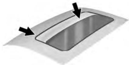
È possibile che sporcizia e altre impurità possano accumularsi nel guida o nella guarnizione del tettuccio apribile. Ciò potrebbe causare un problema con il funzionamento del tetto o il rumore. Potrebbe anche otturare il sistema di drenaggio dell'acqua. Aprire periodicamente il tettuccio e rimuovere tutti gli ostacoli o i residui sciolti. Pulire la tenuta del tettuccio e l'area di tenuta del tetto usando un panno pulito, sapone delicato e acqua. Non rimuovere il grasso dal tettuccio apribile.
