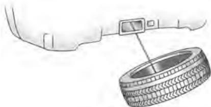
8. Inclinare la ruota verso il veicolo facendo in modo che il cavo non si tenda per accedere al fermo ruota/pneumatico. Rimuovere il fermo dal perno della guida facendolo scorrere sopra il perno e contemporaneamente facendo pressione sul dispositivo di chiusura.
