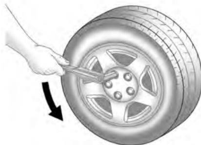
3. Con la chiave per ruote, allentare tutti i dadi della ruota. Ruotare la chiave per ruote in senso antiorario per svitare i dadi delle ruote. Non rimuovere i dadi completamente.
