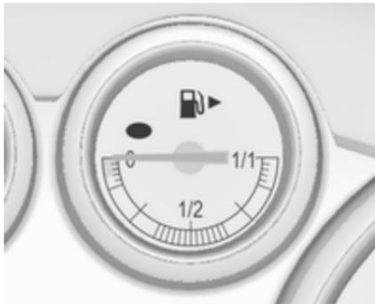
Visualizza il livello del carburante nel serbatoio.
