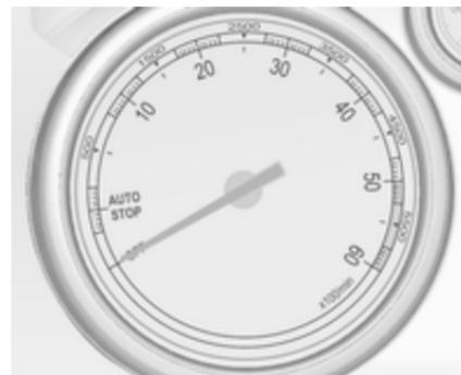
Indica la velocità di rotazione del motore.
