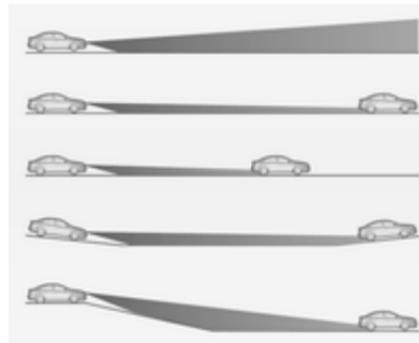
Una speciale funzione di valutazione topografica rileva i veicoli che precedono lungo pendii rilevando il movimento delle luci posteriori davanti. Il sistema regola l'altezza della portata luminosa per garantire l'illuminazione ottimale della superficie stradale antistante senza abbagliare.
