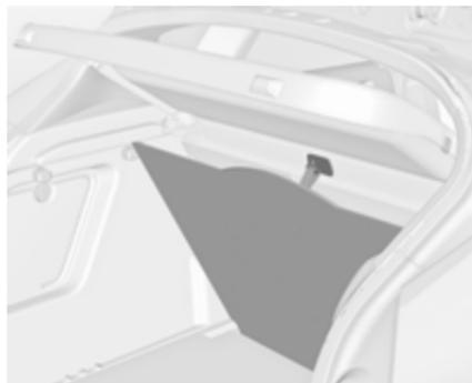
È possibile sollevare la copertura del pavimento posteriore. Inserire l'anello nel gancio sul lato inferiore della copertura del vano di carico.
