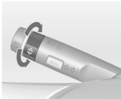
Ruotare la manopola di regolazione per selezionare un'opzione di menu o per impostare un valore numerico.
