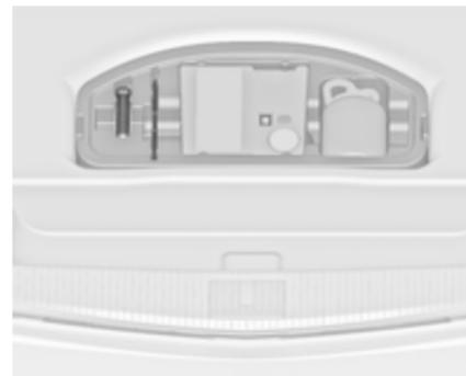
Gli attrezzi e il kit di riparazione dei pneumatici si trovano nel vano portaoggetti sotto la copertura del pianale nel vano di carico.
