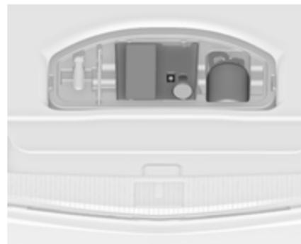
Il kit di riparazione dei pneumatici si trova in uno scomparto sotto la copertura del pianale nel vano di carico.
