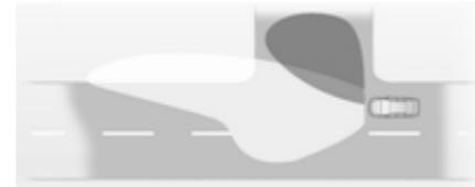
Nelle curve strette o durante le svolte, a seconda dell'angolo di sterzata o del segnale dell'indicatore di direzione, viene attivato un riflettore supplementare destro o sinistro che illumina la strada ad angolo retto rispetto al senso di marcia. Si attiva fino ad una velocità massima di 40 km/h.
