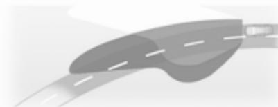
Il fascio di luce ruota a seconda dell'angolo di sterzata del volante e della velocità, migliorando la luminosità in curva.
