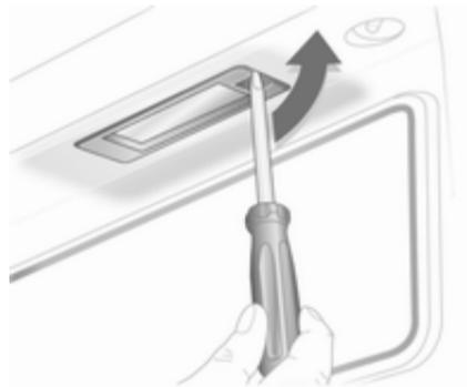
1. Inserire un cacciavite nell'alloggiamento del coperchio, esercitare pressione verso un lato e sganciare la molla. Rimuovere la copertura.
