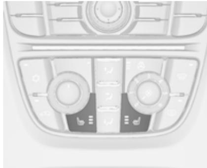
Regolare il riscaldamento sul livello desiderato premendo il pulsante
