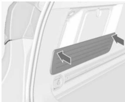
Durante l'assemblaggio, premere la copertura nelle tenute di gomma per ottenere la forza massima di bloccaggio.
