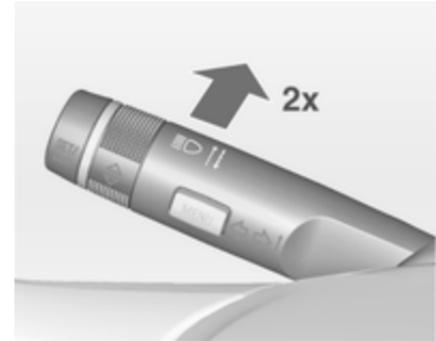
La regolazione intelligente della portata luminosa e l'attivazione automatica degli abbaglianti vengono azionate in contemporanea premendo la leva degli indicatori due volte. Possono essere azionati a quadro acceso.
