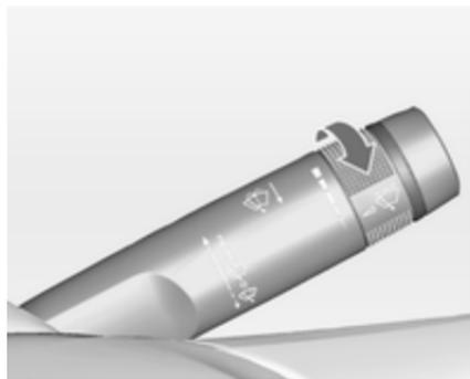
Ruotare la manopola di regolazione per regolare la sensibilità del tergicristalli:
