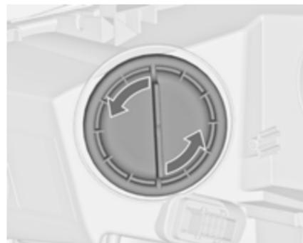
1. Ruotare il coperchio (2) in senso antiorario e rimuoverlo.
