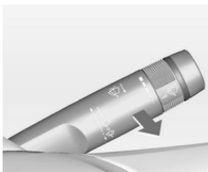
Tirare la leva. Il liquido di lavaggio viene spruzzato sul parabrezza e il tergicristalli effettua alcuni passaggi. Se i fari sono accesi, il liquido di lavaggio viene spruzzato anche sui fari, a condizione che la leva venga azionata per un tempo sufficientemente lungo. Dopo, il sistema di lavaggio dei fari non è operativo per 5 cicli di lavaggio o fino a quando il motore o i fari sono stati spenti e riaccesi.
