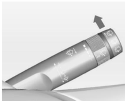
Spingere la leva. Il liquido di lavaggio viene spruzzato sul lunotto posteriore e il tergicristalli effettua alcuni passaggi.
