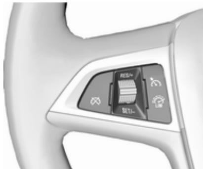
Non utilizzare il controllo automatico della velocità di crociera qualora non sia opportuno il mantenimento di una velocità costante.
