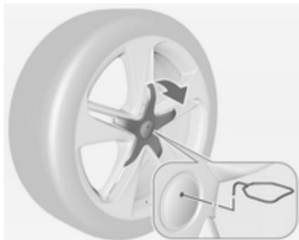
Ruote in lega con copribullone ruota centrale: disinnestare il copribullone inserendo e tirando l'estrattore ⇨ 188 nella cavità dell'emblema del marchio.
