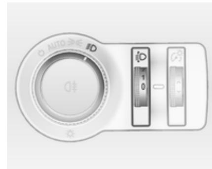
Per regolare la profondità delle luci in base al carico del veicolo e non abbagliare i conducenti dei veicoli in avvicinamento: ruotare la manopola
