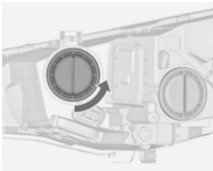
1. Ruotare il coperchio in senso antiorario e rimuoverlo.
