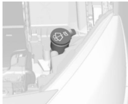
Riempire con acqua pulita miscelata con la giusta quantità di soluzione detergente per cristalli contenente antigelo. Per un rapporto di miscelazione corretto, controllare il contenitore del liquido di lavaggio.
