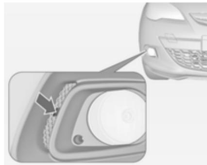
1. Disinnestare la copertura con un cacciavite nella cavità e rimuovere la copertura.
