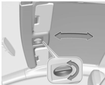
Ruotare la maniglia e spostare la copertura del tetto in una posizione idonea.
