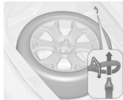
2. Posizionare la parte a cappio della cinghia nell'occhiello di ancoraggio anteriore sul lato appropriato.
