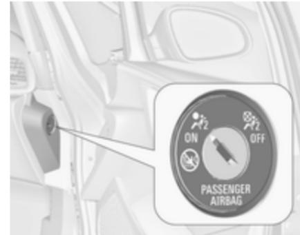
Gli airbag del passeggero anteriore possono essere disattivati tramite un interruttore a chiave nel lato destro del quadro strumenti.
