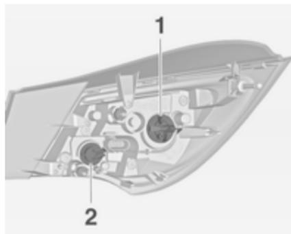
5. Rimuovere e sostituire la lampadina ruotando il portalampada in senso antiorario.
