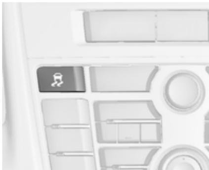
Il sistema di controllo della trazione può essere disattivato quando è richiesto lo slittamento delle ruote motrici: premere brevemente il pulsante
