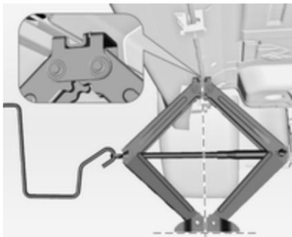
4. Posizionare il martinetto all'altezza necessaria. Posizionarlo direttamente sotto al punto di sollevamento, in modo da impedirne lo scivolamento.
