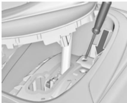
3. Inserire un cacciavite nell'apertura fino alla battuta e spostare la leva del cambio dalla posizione **P** o **N**. Se la leva viene portata nuovamente in posizione **P** o **N**, questa si bloccherà nuovamente in posizione. Rivolgersi ad un'officina per eliminare la causa dell'interruzione dell'alimentazione elettrica.
