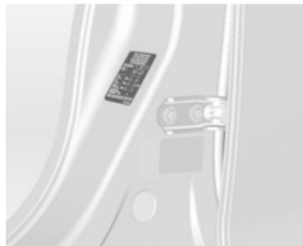
Pressione dei pneumatici ⇄ 226 e sull'etichetta sul telaio della portiera anteriore sinistra.
