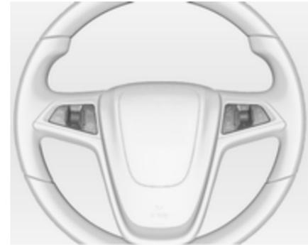
È possibile controllare il sistema Infotainment, il controllo automatico della velocità di crociera, il limitatore di velocità e un telefono cellulare collegato tramite i comandi al volante.
