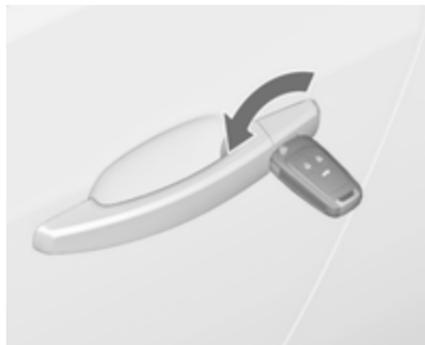
Sbloccare manualmente la portiera del conducente girando la chiave nella serratura. Inserire l'accensione e premere il pulsante di chiusura centralizzata
