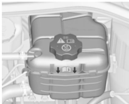
Quando il sistema di raffreddamento è freddo, il livello del liquido di raffreddamento dovrebbe essere al di sopra della tacca di riempimento. Rabboccare se il livello è basso.
