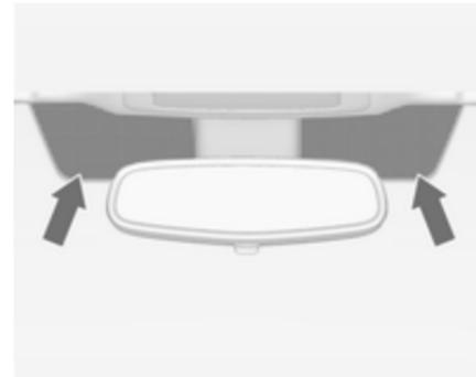
Le aree del parabrezza evidenziate dietro allo specchietto retrovisore interno non sono coperte dal rivestimento. I dispositivi per la registrazione di dati elettronici e il pagamento
