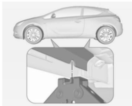
3. Controllare che il martinetto sia in posizione corretta sotto il relativo punto di sollevamento del veicolo. Su versioni con pannello battitacco: prima estrarre la copertura sul pannello battitacco nel rispettivo punto di sollevamento.
