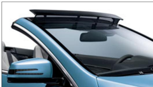
Il modulo antiturbolenza ad azionamento elettrico posto sulla sommità del parabrezza è un componente dell'AIRCAP.
