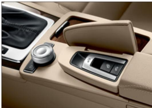
L'interruttore di comando della capote si trova sotto il poggiamano del Controller.
