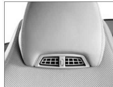
Riscaldamento per la zona della testa AIRSCARF per la Cabrio
