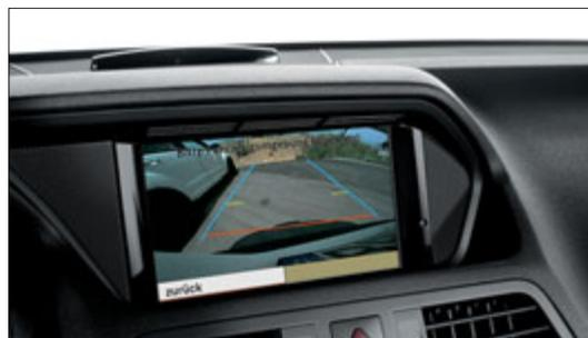
La telecamera per la retromarcia assistita visualizza la zona poco visibile dietro la coda della vettura.
