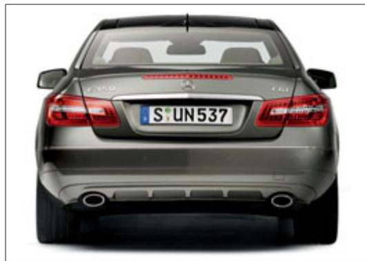
I modelli a 6 cilindri sono equipaggiati con due terminali di scarico ovali.
