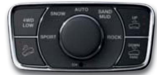
» **SELEC-TERRAIN™.** Cinque modalità diverse per adeguarsi alle condizioni del manto stradale. Questo avanzato dispositivo coordina simultaneamente diversi sistemi, fra cui Hill Start Assist (HSA), Hill Descent Control (HDC), controllo della trazione, Electronic Stability Control (ESC), come pure cambio, differenziali e motore, per garantire sempre la massima trazione.
