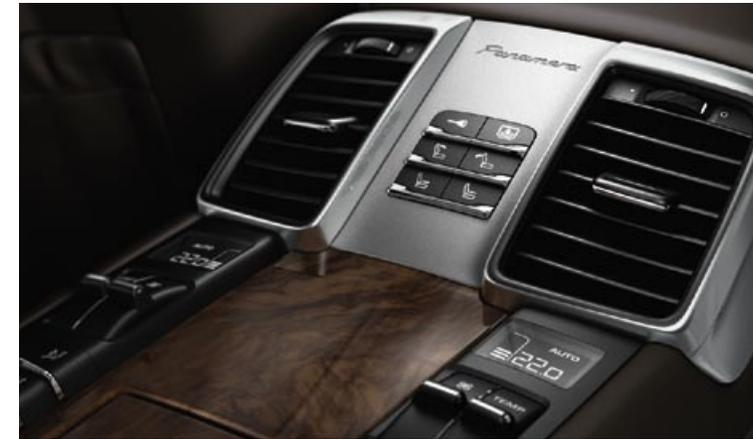
Climatizzatore automatico a 4 zone posteriore
