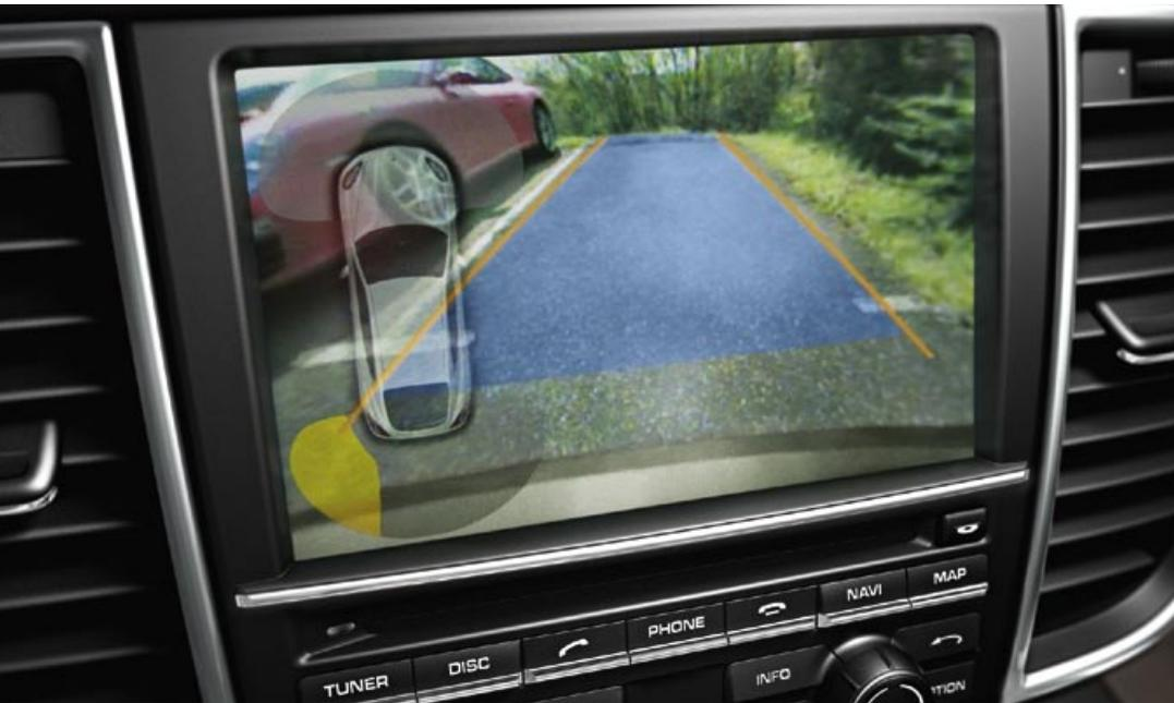
Riproduzione delle immagini dalla telecamera posteriore nel PCM
