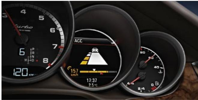
Sistema adattivo di regolazione della velocità (ACC)
