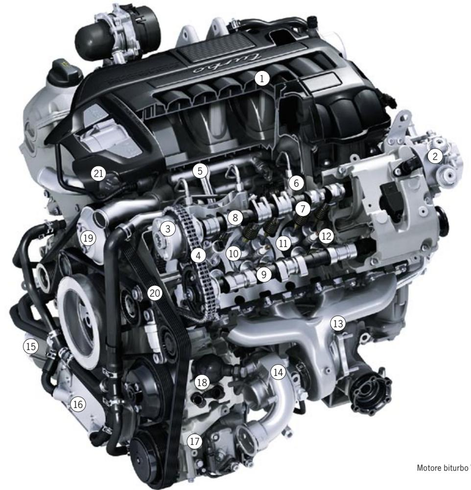
Motore biturbo V8
