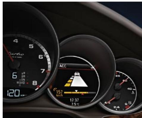
Sistema adattivo di regolazione della velocità (ACC)
