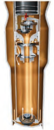
Estensione – solo pistone principale, impostazione sportivamente rigida
