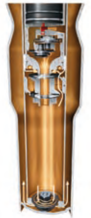
Compressione – solo pistone principale, impostazione sportivamente rigida
