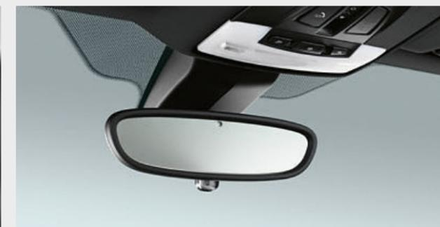
□ Retrovisore interno e retrovisore esterno lato guida con funzione di auto-oscuramento, inclusa la funzione ripiegamento per i retrovisori esterni e la funzione automatica «bordo marciapiede» per il retrovisore esterno lato passeggero anteriore.
