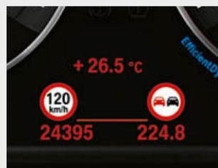
□ Lo Speed Limit Info<sup>2</sup> con indicatore di divieto di sorpasso segnala il limite di velocità valido al momento e l'eventuale presenza di un divieto di sorpasso. Le informazioni sono visualizzate sull'Info Display nel quadro strumenti o sull'Head-Up Display.
