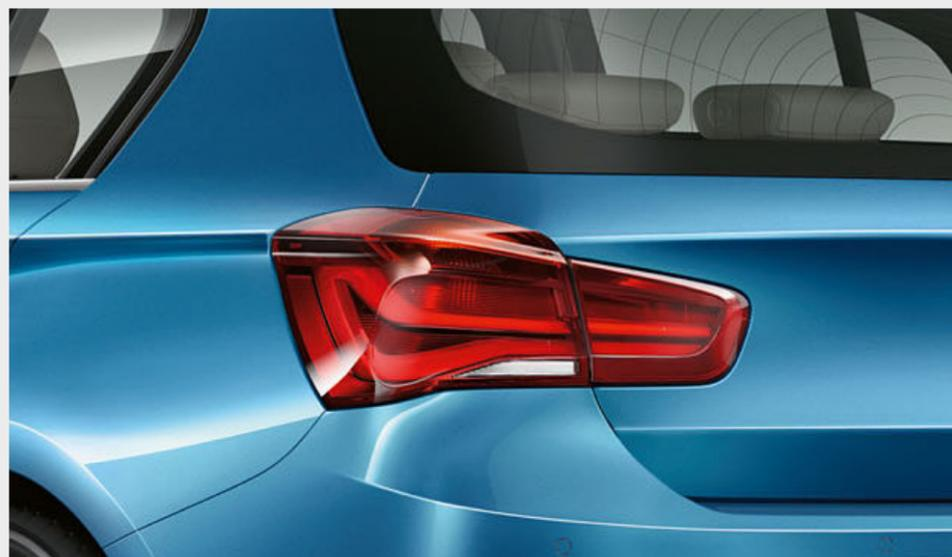
■ I gruppi ottici posteriori in due parti nel caratteristico design a L sono dotati di tecnologia LED. Presentano entrambi elementi luminosi nella carrozzeria e nel portellone posteriore. Grazie alla funzione di luce stop dinamica, con luci lampeggianti, i veicoli che seguono vengono immediatamente avvertiti in caso di una vostra frenata a fondo, ad esempio in situazioni di emergenza.
