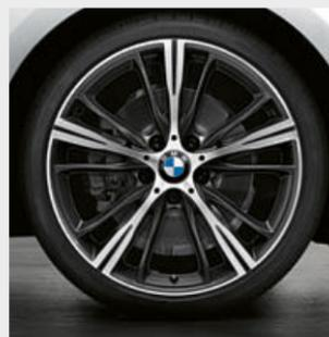
○ Cerchi in lega leggera da 19", styling a stella n° 660 in Orbit Grey bicolore, torniti a specchio sul lato a vista. Set di ruote complete estive RDC con pneumatici misti Runflat, dimensioni 7,5J x 19 ant. 225/35 R19 88Y XL e post. 8J x 19 con 245/30 R19 89Y XL.
