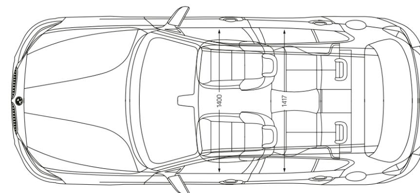
Tutti i dati dei disegni tecnici sono espressi in millimetri (nell'immagine è visibile la BMW Serie 1 a 5 porte) Le dimensioni interne della BMW Serie 1 a 3 porte sono leggermente diverse.
