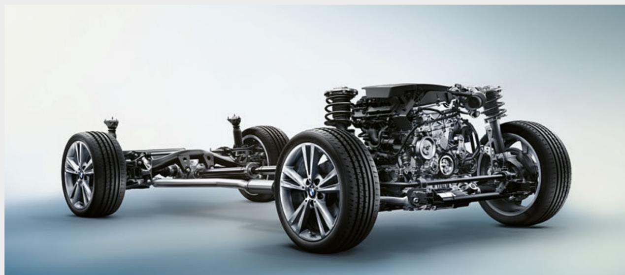
La ripartizione ideale del peso sugli assi in **rapporto 50:50** garantisce elevata stabilità direzionale, maneggevolezza, agilità e dinamica di guida. Il baricentro basso e gli sbalzi ridotti migliorano ulteriormente le doti dinamiche della vettura.
