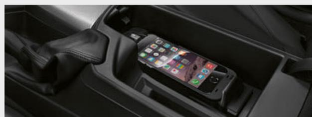
□ L'interfaccia Bluetooth<sup>3</sup> con connettività estesa, ricarica wireless e hot-spot WLAN comprende una tasca per la ricarica senza fili e due prese USB. La ricezione di radiotelefonata mobile migliora grazie all'utilizzo dell'antenna sul tetto. Attraverso il Bluetooth si possono collegare contemporaneamente due telefoni mobili e un lettore audio. Sono anche disponibili il Bluetooth Office e l'hotspot WLAN.
