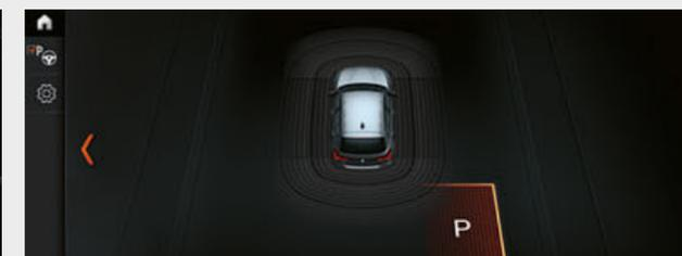
□ Il Park Assistant facilita le manovre di parcheggio parallele e trasversali alla corsia di marcia. Marciando a basse velocità, il sistema rileva anche gli spazi più ristretti per un eventuale parcheggio. Quando viene rilevato uno spazio adatto, il Park Assistant prende il controllo dello sterzo, mentre il conducente inserisce la marcia corretta, preme il pedale dell'acceleratore o frena.
