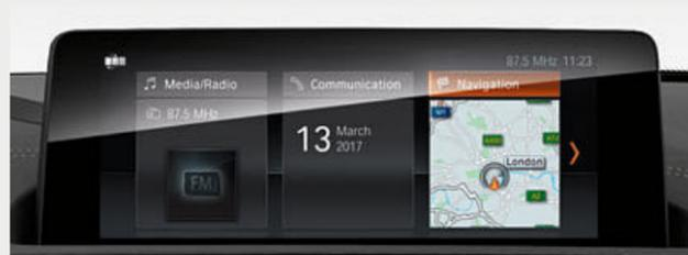
□ Il Sistema di Navigazione BMW ConnectedPro, include interfaccia USB, schermo LCD a colori da 8,8" e Radio BMW Professional con lettore DVD ed è dotato di rappresentazione tridimensionale delle mappe e 20 GB di memoria. Il sistema viene gestito in modo intuitivo tramite l'iDrive Touch Controller o schermo touch. L'aggiornamento delle mappe è disponibile gratuitamente per tre anni.
