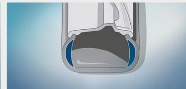
■ L'**indicatore di pressione dei pneumatici** mostra l'esatto livello di pressione in ogni momento e in caso di perdita avvisa automaticamente il conducente. I sensori presenti su ogni cerchio registrano i dati e li trasmettono all'unità di controllo con metodo wireless. In questo modo, l'indicatore di pressione pneumatici segnala sia le perdite rapide che le perdite più lente.
