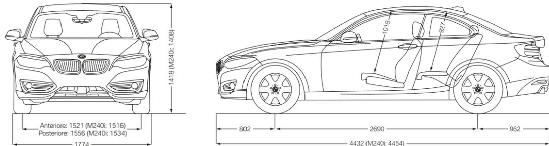
Tutte le misure dei disegni tecnici sono espresse in millimetri. L'altezza senza antenna è di 1466 mm. I dati relativi a prestazioni, consumi ed emissioni di CO<sub>2</sub> si riferiscono alle vetture con cambio di serie. I valori tra [ ] si riferiscono ai modelli con cambio Steptronic.
