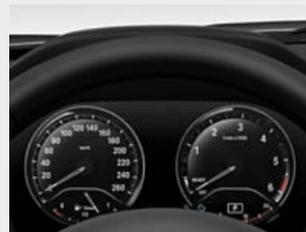
□ Il quadro strumenti con funzionalità estese include un Info Display per la presentazione delle informazioni di navigazione e di diversi messaggi.
