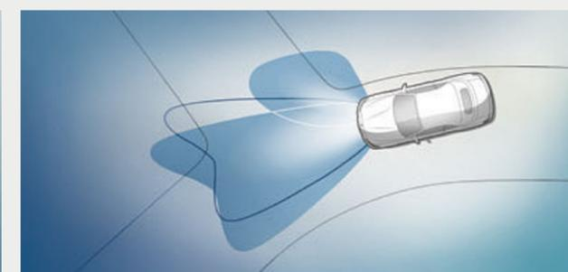
□ I **fari LED adattivi** sono realizzati completamente con tecnologia LED e includono gli indicatori di direzione, gli anabbaglianti, gli abbaglianti e le luci diurne per la massima sicurezza durante la guida. L'High-Beam Assistant e l'Adaptive Light Control con distribuzione variabile del fascio luminoso migliorano la visibilità di notte riducendo l'affaticamento del guidatore.
