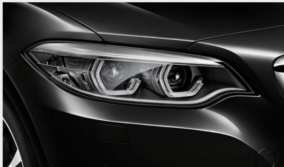
□ I fari LED adattivi sono realizzati completamente con tecnologia LED e includono gli indicatori di direzione, gli anabbaglianti, gli abbaglianti e le luci diurne per la massima sicurezza durante la guida. L'High-Beam Assistant e l'Adaptive Light Control con distribuzione variabile del fascio luminoso migliorano la visibilità di notte riducendo l'affaticamento del guidatore.
