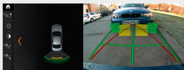
□ La telecamera posteriore migliora inoltre l'orientamento durante la retromarcia a velocità inferiori a 15 km/h, ad esempio nelle manovre di parcheggio. Visualizza sul Control Display la zona dietro la vettura. Le linee interattive misurano la distanza e il diametro di sterzata, assistendo il guidatore nella manovra. Gli ostacoli sono contrassegnati mediante colori.
