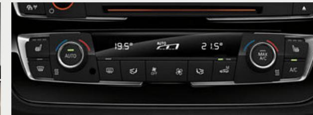
□ Il climatizzatore automatico bi-zona con controllo automatico della temperatura ha comandi separati per il conducente e il passeggero. Comprende bocchette d'aria posteriori, Controllo automatico ricircolo aria (AUC), un filtro a carboni attivi, sensori solari e antiappannamento e regolazione automatica giorno/notte nel display da bianco ad arancione.
