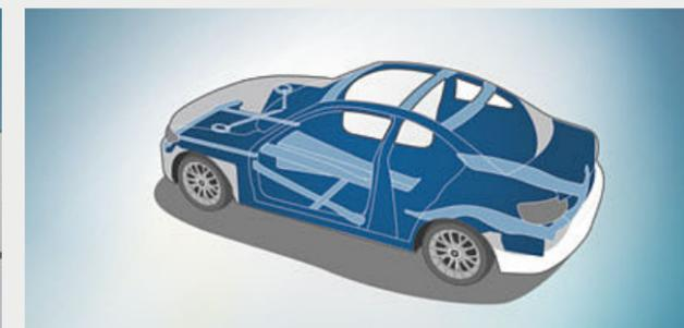
■ Grazie alla sua struttura funzionale con speciale dislocazione degli elementi portanti e speciali collegamenti nodali, nonché all'impiego mirato di materiali ad alta resistenza, la **cellula abitacolo** offre un grado ottimale di sicurezza passiva in caso di impatto frontale, laterale e posteriore.
