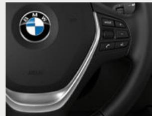
■ I Comandi multifunzione al volante possono essere utilizzati per comandare il telefono, il comando vocale, le funzioni audio e il limitatore manuale di velocità.
