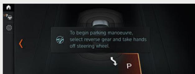
□ Il Park Assistant facilita le manovre di parcheggio parallele e trasversali alla corsia di marcia. Marciando a basse velocità, il sistema rileva anche gli spazi più ristretti per un eventuale parcheggio. Quando viene rilevato uno spazio adatto, il Park Assistant prende il controllo dello sterzo, mentre il conducente inserisce la marcia corretta, preme il pedale dell'acceleratore o freno.
