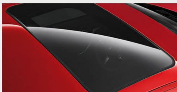
□ Il tettuccio in vetro scorrevole e sollevabile a comando elettrico con protezione solare, protezione antincaastro, apertura e chiusura comfort telecomandata e funzione one-touch permette ai passeggeri di regolare in base ai propri gusti il flusso dell'aria, creando il clima ideale a bordo. Il deflettore frangivento integrato ad estrazione automatica garantisce il massimo livello di comfort acustico.
