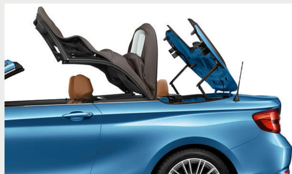
■ La capote della cabrio riduce la rumorosità all'interno dell'abitacolo e fornisce un isolamento ottimale dal freddo. Sia all'interno che all'esterno presenta un look particolarmente raffinato. La capote elettrica è apribile e chiudibile durante la guida a velocità fino a 50 km/h.
