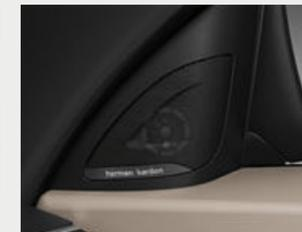
□ Il Sistema HiFi Harman Kardon con amplificatore esterno da 360 watt nel bagagliaio è costituito da 12 casse inclusi due subwoofer centrali.
