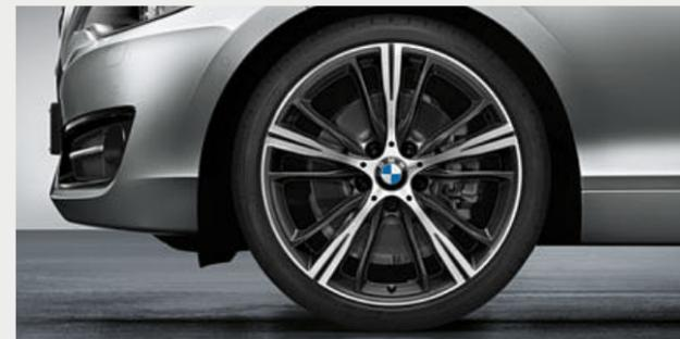
○ Cerchi in lega leggera da 19", styling a stella n° 660 in Orbit Grey bicolore, torniti a specchio sul lato a vista. Set di ruote complete estive RDC con pneumatici misti Runflat, dimensioni 7,5J x 19 ant. 225/35 R19 88Y XL e post. 8J x 19 con 245/30 R19 89Y XL.
