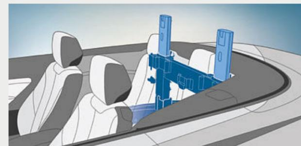
■ Il **sistema di protezione antibaltamento**<sup>1</sup> nei poggiatesta posteriori unito ai rollbar integrati nel telaio del parabrezza costituisce la cellula abitacolo. In caso di collisione rollbar protettivi integrati nei poggiatesta fuoriescono in poche frazioni di secondo offrendo protezione per la testa e aumentando la sicurezza.
