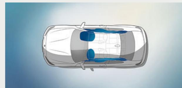
■ Gli **airbag** per guidatore e passeggero anteriore fanno parte del sistema di sicurezza BMW nel quale tutti i componenti sono armonizzati in modo ottimale. Complessivamente sono presenti sei airbag per la massima sicurezza. Sono gli airbag per il guidatore e il passeggero anteriore, gli airbag per la testa per le superfici dei finestrini laterali<sup>2</sup> e gli airbag laterali negli schienali dei sedili anteriori.
