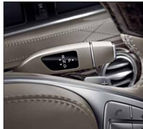
Leva del cambio DIRECT SELECT sul volante. Per passare a una marcia superiore o inferiore anche manualmente.
