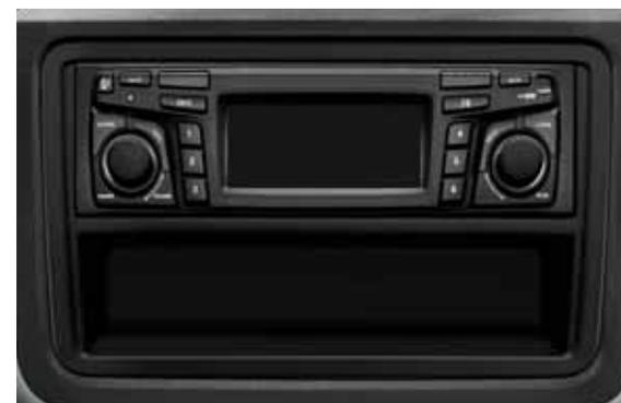
**Kit di montaggio** (AZO 700 001) e **cavo adattatore** (AZA 700 001A) necessari per l'installazione di una radio non originale su una vettura con predisposizione per autoradio ŠKODA.
