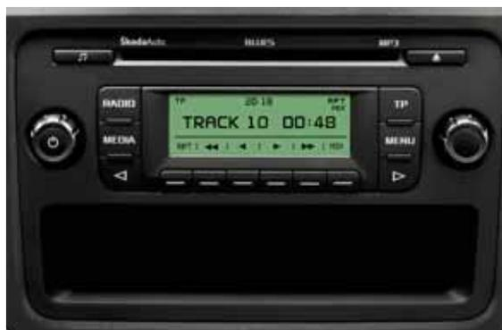
**Radio Blues:** lettore CD per CD audio e file audio MP3, AM/FM tuner con sistema RDS, pratica crittografia elettronica che permette l'utilizzo solo su un veicolo specifico, potenza amplificatore 4x 20 W (5J0 035 152B)
