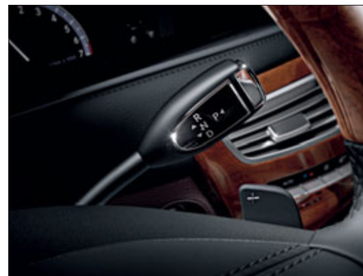
La leva del cambio al volante DIRECT SELECT consente di azionare il cambio premendo un pulsante
