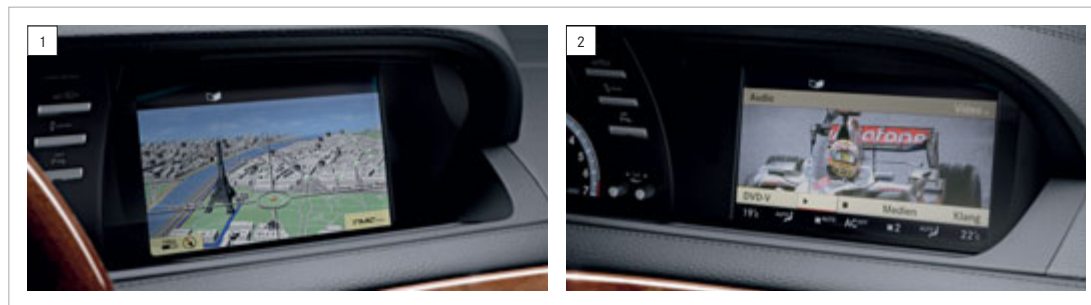
Lo SPLITVIEW permette a guidatore (1) e passeggero (2) di visualizzare contemporaneamente contenuti diversi su un unico schermo
