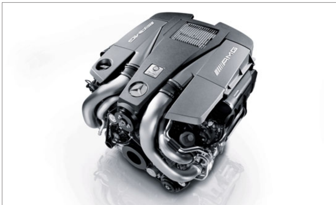
Nuovo V8 biturbo AMG da 5,5 litri da 420 kW (571 CV) di potenza e 900 Nm di coppia
