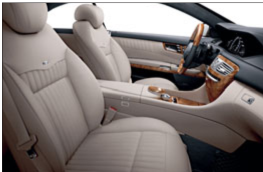
Sedili anteriori Multicontour a conformazione variabile in funzione della situazione di marcia e con funzione di massaggio
