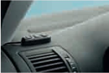
**Kit per il montaggio supplementare del dispositivo viva-voce** con modulo a pulsante e senza touchscreen (5J0 051 473A)
