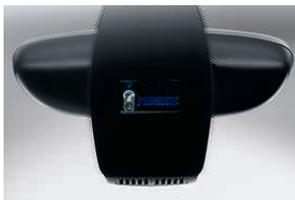
□ **Sensore pioggia con accensione anabbaglianti**: una volta attivato, il sensore pioggia mette in funzione automaticamente i tergicristalli secondo l'intensità della pioggia e ne regola la frequenza. L'accensione automatica degli anabbaglianti accende i fari al calare del buio o all'interno delle gallerie. Di serie per la versione Futura.
