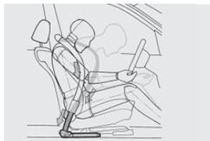
■ **Sistema di ritenzione BMW per guidatore e passeggero:** la combinazione di cintura di sicurezza a tre punti, pretensionatori pirotecnici, limitatori di ritenzione assicura la massima efficacia di ritenzione in caso d'urto.
