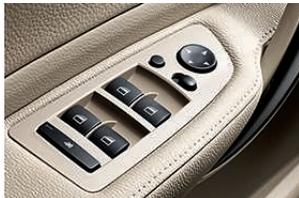
■ **Alzacristalli elettrici anteriori**, interruttore a strappo/pressione con funzione di abbassamento/sollevamento con un semplice impulso, chiusura «comfort» di tutti i cristalli e protezione antischiacciamento.
