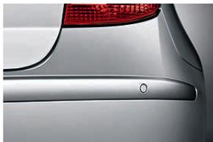
□ **Park Distance Control (PDC)**, disponibile per parte anteriore e posteriore o soltanto posteriore: facilita il parcheggio e la manovra in spazi ristretti; l'avvicinamento dell'auto ad un ostacolo viene indicato tramite segnali acustici (in abbinamento al sistema di navigazione, anche visivamente sul Control Display). La versione Futura ha di serie il PDC posteriore.
