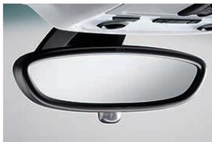
□ **Retrovisore interno,** autoanabbagliante a superficie molto ampia; lo specchio si oscura automaticamente a seconda dell'intensità luminosa dei fari di veicoli che seguono. Di serie per versione Futura.
