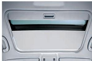
□ **Tettuccio scorrevole/inclinabile in vetro,** ad azionamento elettrico, con apertura «comfort» tramite il telecomando.
