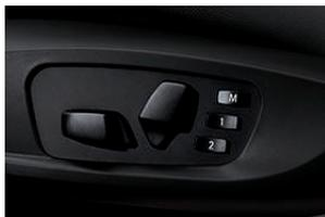
□ **Regolazione elettrica dei sedili anteriori**: regolazione in altezza del sedile e inclinazione dello schienale; regolazione del sedile in senso longitudinale e in inclinazione; funzione Memory per sedile di guida e retrovisori esterni (compreso dispositivo automatico «bordo marciapiede»). Si possono memorizzare due posizioni personalizzate per il sedile di guida e i retrovisori esterni.
