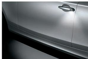
□ **Pacchetto luci**: comprende le luci incorporate nelle maniglie delle portiere, che, allo sbloccaggio delle stesse, illuminano per 20 secondi la zona di accesso, consentendo di salire con sicurezza nell'auto anche al buio. Ulteriori punti luce: luci di lettura davanti e dietro con illuminazione ambiente, luce nel vano piedi anteriore e specchietti di cortesia illuminati per guidatore e passeggero, illuminazione a luce diffusa. Di serie per Futura.
