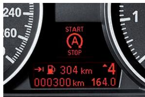
■ **Indicatore di Start/Stop automatico** (per tutti i modelli a quattro cilindri in abbinamento al cambio manuale a 6 marce): segnala sull'Info Display quando il motore viene spento dalla funzione di Start/Stop automatico (ad es. se si è fermi al semaforo o in coda). Il segnale si spegne quando il motore viene acceso nuovamente.
