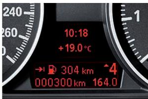
■ **Computer di bordo**: indica la velocità media, il consumo medio e quello del momento, l'autonomia e la temperatura esterna. Segnala inoltre il pericolo di manto stradale ghiacciato per temperature al di sotto dei 3°C.
