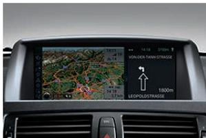
□ **Sistema di navigazione Professional**: con Radio Professional e lettore DVD, controller iDrive con pulsanti di selezione e otto pulsanti programmabili, disco rigido integrato per mappe cartografiche e file audio, display fisso da 8,8" ad alta risoluzione, navigazione cartografica, con vista 3D a «volo d'uccello».
