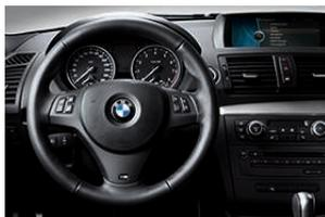
□ **Volante in pelle M** (diametro 369 mm) a tre razze, con multifunzione (optional) per i comandi della radio o del telefono. Comprende leva del freno a mano, cuffia e pomello del cambio in pelle Walknappa. Di serie per M Sport.
