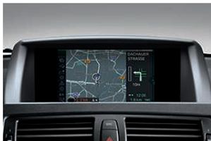
□ **Sistema di navigazione Business**, incl. radio Professional con lettore CD, iDrive Controller con pulsanti di selezione, pulsanti programmabili, memoria integrata per i dati di navigazione, navigazione tramite mappe e/o frecce direzionali e display ad alta risoluzione da 6,5 pollici.
