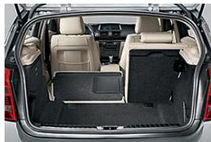
■ **Schienale posteriore,** divisibile nella misura di 60:40. Abbassandolo si ottiene un piano di carico pressoché continuo.
