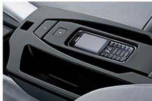
□ **Interfaccia Bluetooth per cellulare** con dispositivo viva voce, attacco per ricarica ed antenna esterna. Tramite un adattatore Snap-In, disponibile separatamente, è possibile collegare un telefonino Bluetooth, azionabile anche tramite l'iDrive (in abbinamento al sistema di navigazione).
