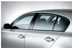
□ **Shadow Line lucida montante B**, guida verticale finestrini posteriori, supporto e cornice dello specchietto retrovisore esterno in nero lucido (di serie per 130i e 123d, solo per la BMW Serie 1 a 5 porte).
