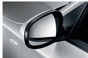
■ **Retrovisori esterni**, in tinta con la carrozzeria, orientabili elettricamente e asferici sul lato conducente. Gli specchi sono riscaldabili per la 130i e la 123d.
