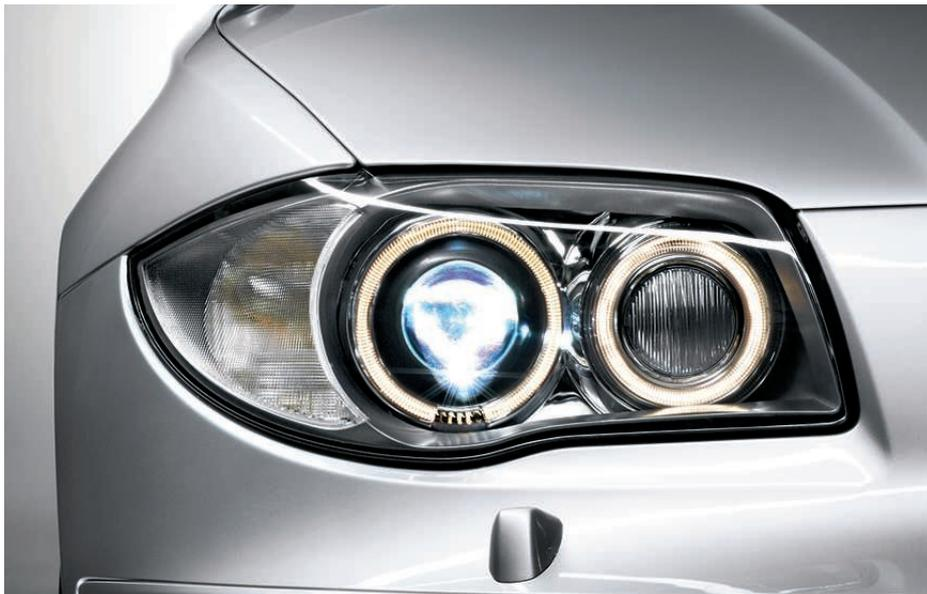
□ **Fari allo xeno anabbaglianti ed abbaglianti**, con quattro anelli luminosi per luci di posizione e regolazione automatica della profondità; illuminano meglio la carreggiata di notte e in tutte le condizioni di scarsa visibilità.
