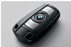
■ **Car Memory/Key Memory:** con la Car Memory è possibile programmare, ad esempio, l'accensione automatica degli anabbaglianti all'avviamento del motore; con la Key Memory, invece, è possibile codificare la posizione abituale del sedile a regolazione elettrica, della radio e del climatizzatore automatico sulla propria chiave e, aprendo la chiusura centralizzata, questa posizione viene ripristinata automaticamente.
