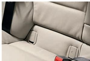
□ **Fissaggio universale ISOFIX** per entrambi i sedili posteriori (opzionale per il sedile del passeggero anteriore) per sistemare in tutta sicurezza un seggiolino per bambini. In combinazione con il sistema ISOFIX anteriore è possibile disattivare l'airbag del passeggero.
