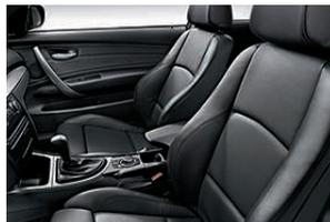
□ **I sedili anteriori sportivi** (visibili nella foto con il rivestimento optional in pelle «Boston») garantiscono un sostegno laterale perfetto grazie allo schienale regolabile elettricamente in larghezza. La posizione longitudinale, l'altezza e l'inclinazione del sedile e dello schienale e la profondità della seduta sono regolabili manualmente. Di serie per Attiva e per MSport.
