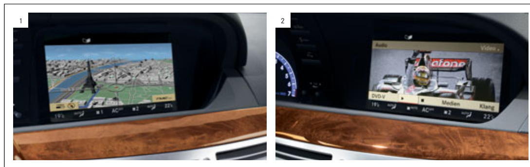
Lo SPLITVIEW permette a guidatore (1) e passeggero (2) di visualizzare contemporaneamente contenuti diversi su un unico schermo.
