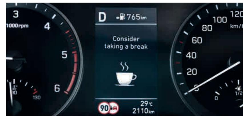
**Sistema di rilevamento della stanchezza del conducente (DAW)**
