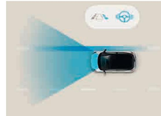
**Sistema di mantenimento della corsia (LKA)**
