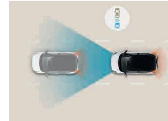
**Sistema anti-collisione frontale con riconoscimento veicoli e pedoni (FCA)**
