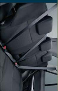
I sedili posteriori nei modelli a 5 porte sono dotati di cinture di sicurezza Etk e tre punti d'ancoraggio.
