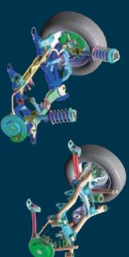
Le sospensioni totalmente indipendenti di Grand Vitara, con le MacPherson all'anteriore e le Multi-link al posteriore abbinati ad una scocca ad alta rigidità, conferiscono alla vettura elevate doti di comfort e tenuta di strada.
