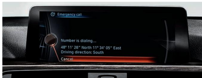
Nel caso di un incidente viene informato automaticamente il call center di BMW Assist.
