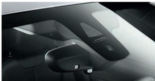
Il Sensore Pieggià si trova sul bordo superiore del parabrezza di fronte al retrovisore interno.
