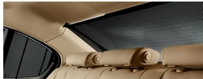
A seconda del modello la tendina parasole avvolgibile per il lunotto può essere azionata elettricamente.
