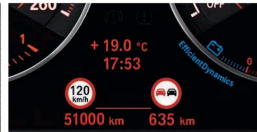
Visualizzazione dell'Indicatore di Speed Limit e del divieto di sorpasso nella strumentazione combinata.
