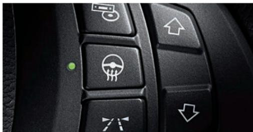
Semplicemente premendo un pulsante la corona del volante si riscalda in brevissimo tempo.
