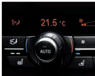
Impostazione separata della temperatura per guidatore e passeggero anteriore.
