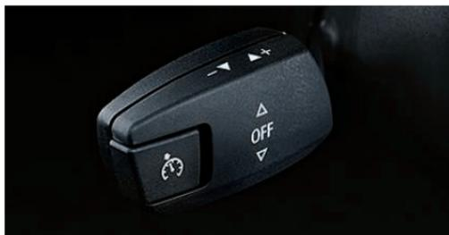
Interruttore sul piantone dello sterzo per attivare comodamente la regolazione di velocità.
