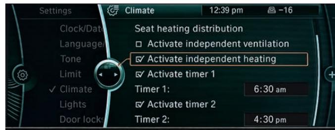
Attraverso l'iDrive si può anche programmare il riscaldamento a vettura ferma affinché si attivi automaticamente all'istante desiderato.
