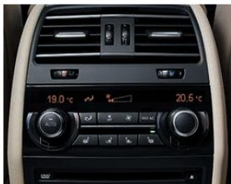
Il climatizzatore automatico quadrizona regola la temperatura individualmente anche nel retro dell'abitacolo con manopola e display.
